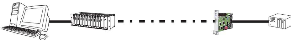
La connexion sur des lignes spécialisées ou louées peut être réalisée indifféremment en 2 fils ou 4 fils.
