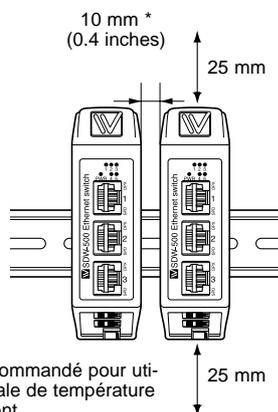
\* Espacement recommandé pour utiliser la plage totale de température en fonctionnement
