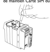
Appuyer sur le bouton pour éjecter le berceau, placer la puce de la carte SIM sur le berceau en respectant le sens de montage :(détrompeur : contact de la puce orienté vers le support modem). Replacer ensuite le berceau sur le modem jusqu'au point de verrouillage.
