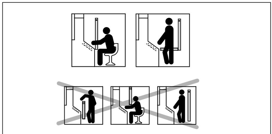
Fig. 2-2 : Montage des C 2000 : les possibilités de passage par dessus, dessous, par les côtés et par derrière doivent être éliminées.
