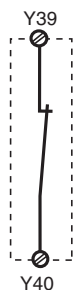
Fig. 8: Öffnerkontakt für Reset der Verzögerungszeit/N/C contact for resetting the Delay-on De-energisation/Contact à ouverture pour mise à 0 de la temporisation
