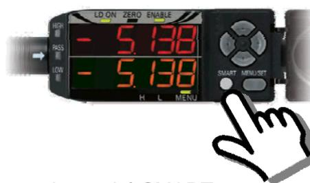
Appuyez sur la touché SMART pendant 1 secondes pour activer la fonction simple Smart Tuning, 2 secondes pour activer la fonction multi Smart Tuning et 5 secondes pour activer la fonction continue Smart Tuning.
