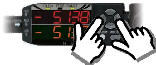
Appuyez simultanément sur les flèches GAUCHE et DROITE pendant 3 secondes.
