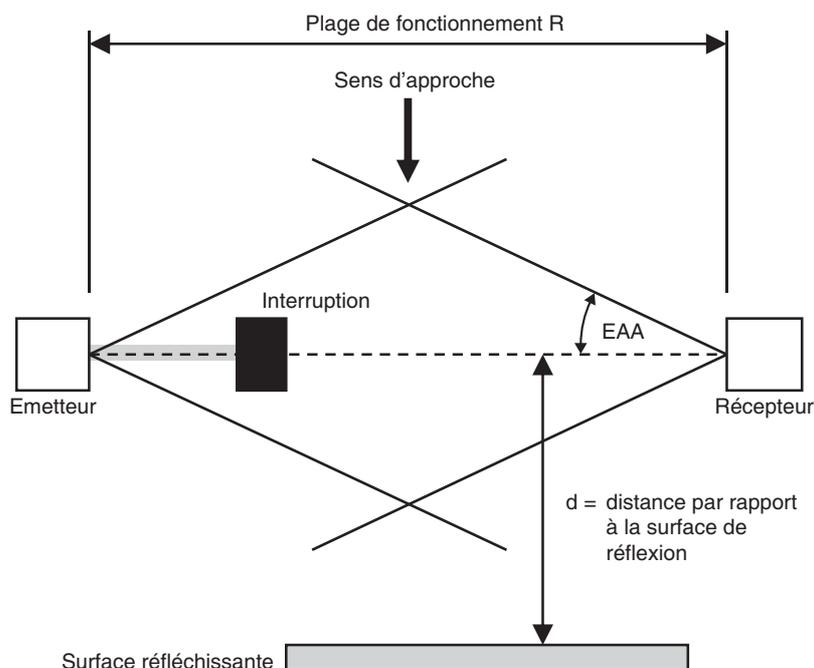
Plage de fonctionnement,  $R$  : il s'agit de la distance de fonctionnement efficace du système F3S-TGR-CL, de l'émetteur au récepteur.
