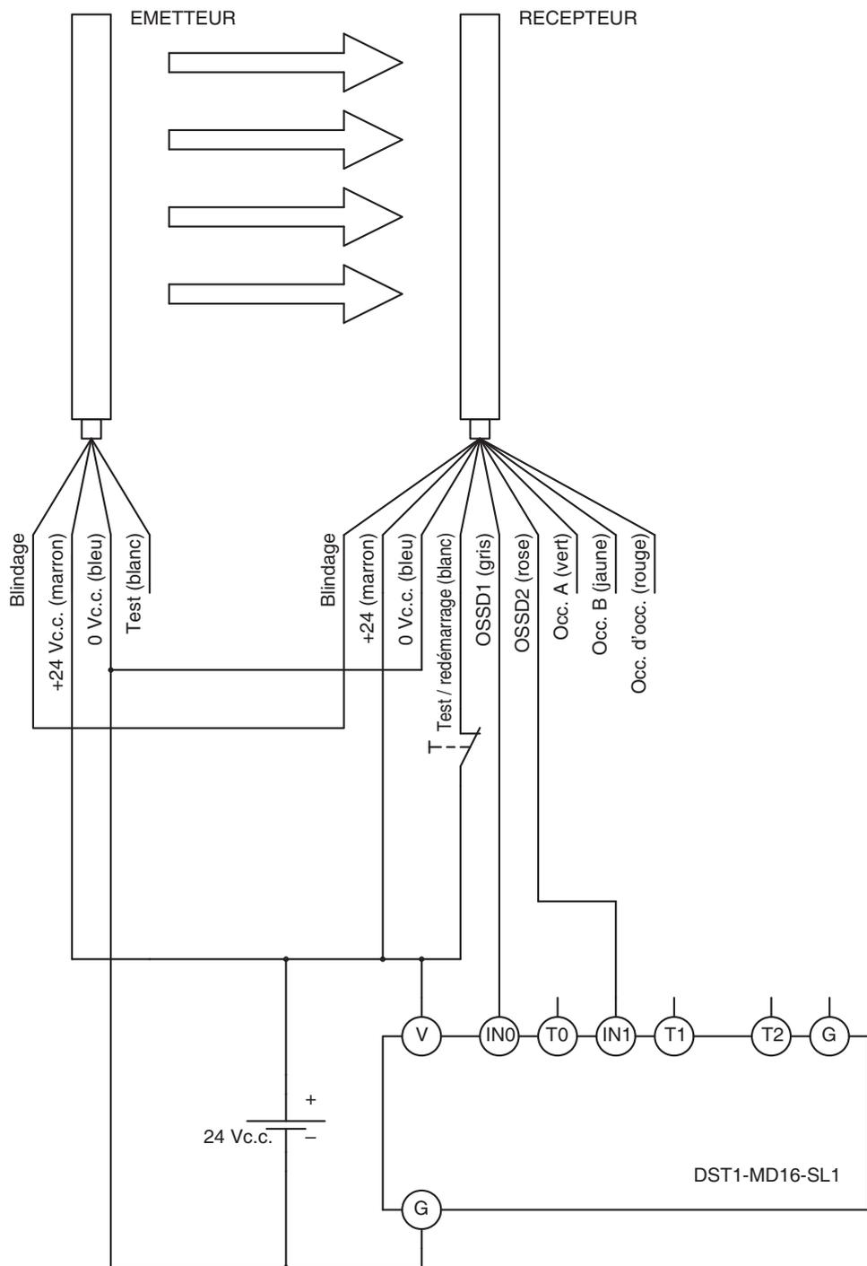
**Remarque** Le niveau de performance ou la catégorie de sécurité susceptible d'être atteint à l'aide de ce circuit dépend de la barrière immatérielle de sécurité qui est utilisée et du câblage correct de l'unité de contrôle de sécurité.
