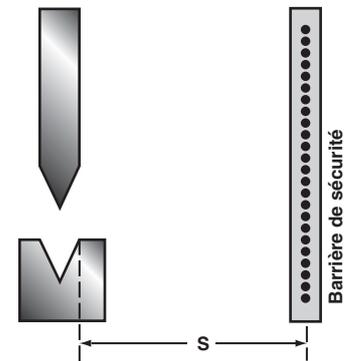
Un système F3S-TGR-CL doit être placé assez loin de la zone de danger de sorte que la machine s'arrête avant qu'une main ou une autre partie du corps de l'opérateur ne pénètre dans la zone de danger. Cette distance est appelée distance de sécurité. Il s'agit d'une valeur calculée à partir d'une formule.
