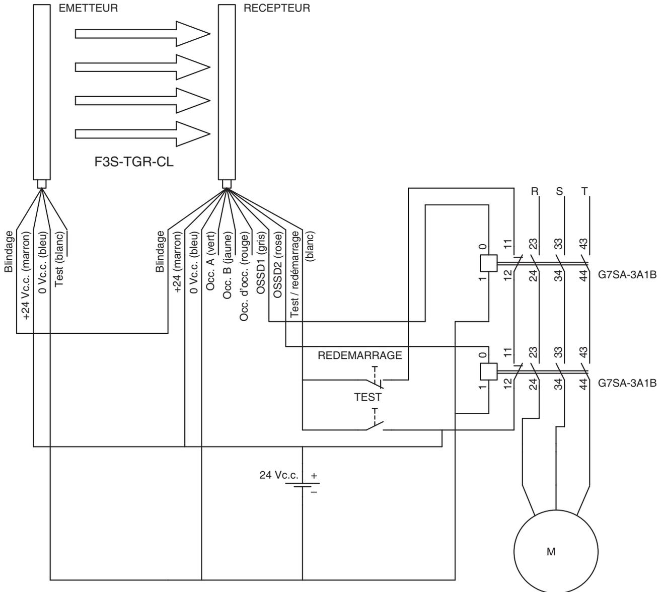
**Remarque** Le niveau de performance ou la catégorie de sécurité susceptible d'être atteint à l'aide de ce circuit dépend de la barrière immatérielle de sécurité qui est utilisée et du câblage correct de l'unité de contrôle de sécurité.
