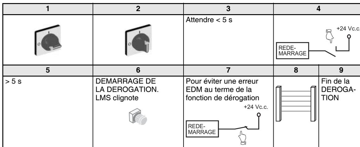
La fonction de dérogation est immédiatement interrompue si l'entrée TEST / RESTART est activée pendant la mise en oeuvre de cette fonction.
