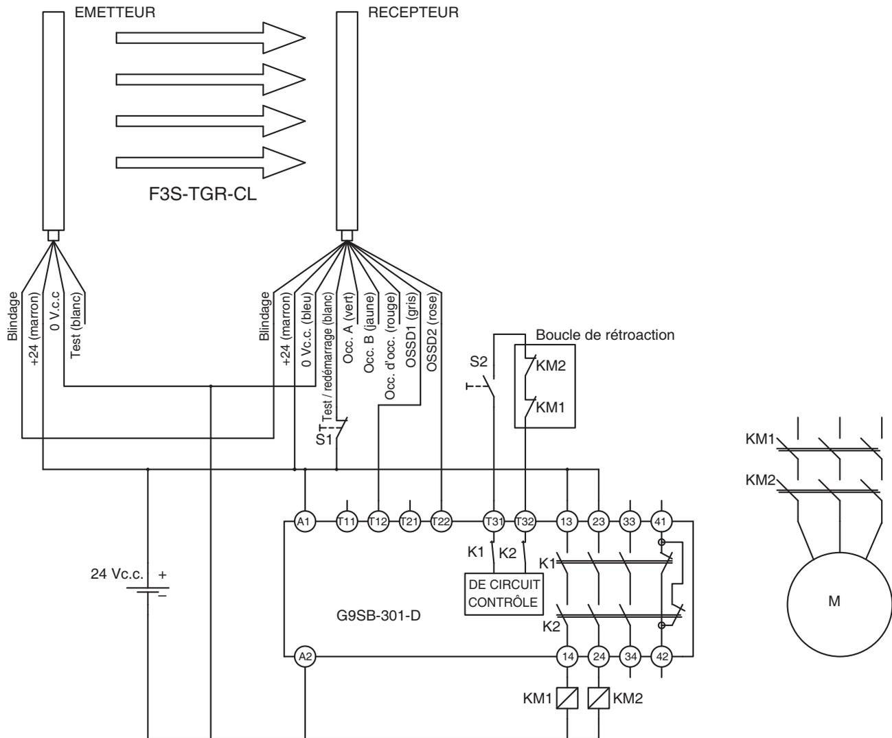
**Remarque** Le niveau de performance ou la catégorie de sécurité susceptible d'être atteint à l'aide de ce circuit dépend de la barrière immatérielle de sécurité qui est utilisée et du câblage correct de l'unité de contrôle de sécurité.
