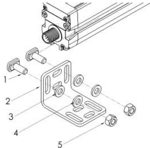
**Remarque** Le nombre de supports de montage livrés avec les produits tient compte de la recommandation stipulant qu'il faut utiliser un support de montage tous les 400 mm.
