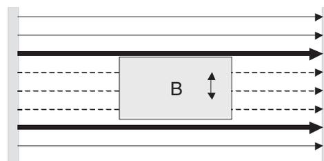
→ Les faisceaux susceptibles d'être obscurcis en raison du mouvement ou de la vibration de B
