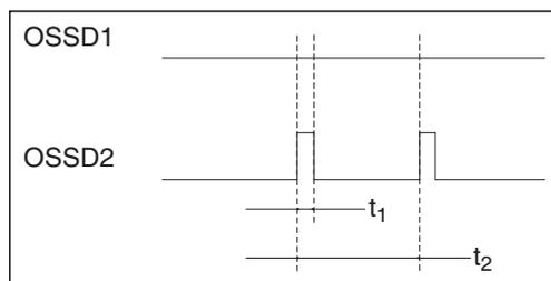
$t_1$  Impulsion de test  $\leq 70 \mu s$
