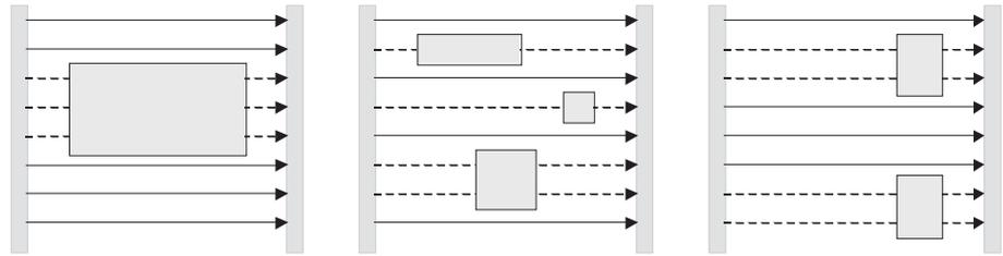
Le système F3S-TGR-CL surveille le nombre de faisceaux bloqués. La position de l'objet (des objets) n'est pas surveillée.
