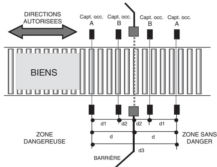
Ce mode d'activation de l'occultation permet un transport bidirectionnel des matériaux.
