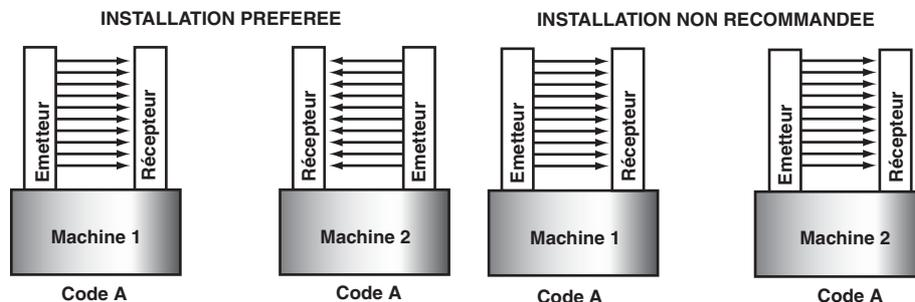
La fonction de code de balayage du système F3S-TGR-CL permet de placer des systèmes à faible distance les uns des autres et alignés. Le codage distinctif des faisceaux garantit le fonctionnement unique d'un système utilisé en parallèle à un autre système muni d'un autre code de balayage. Deux codes uniques sont disponibles sur le système F3S-TGR-CL.
