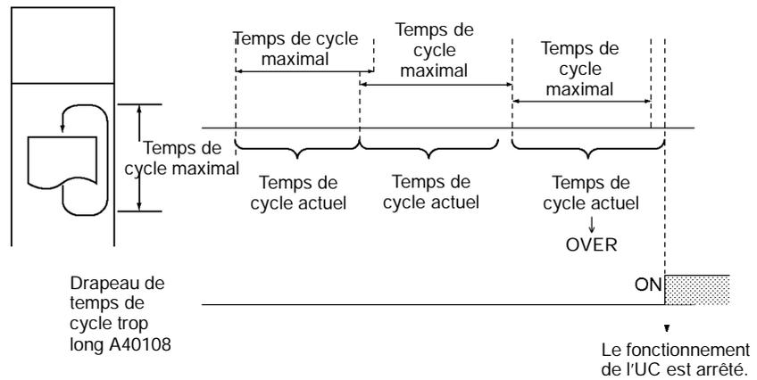
Rem. La valeur par défaut du temps de cycle maximal est de 1 s (1 000 ms).
