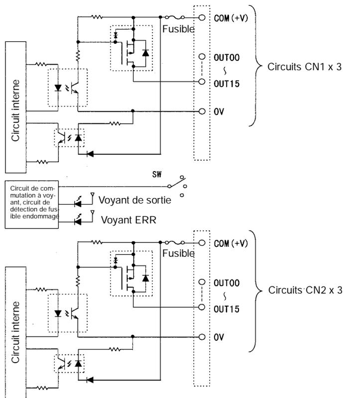
Rem. Le voyant ERR s'allume si un fusible est endommagé ou si l'alimentation externe est à OFF et le drapeau correspondant dans la zone information de l'Unité d'E/S de base (A050 à A089) passe à ON.
