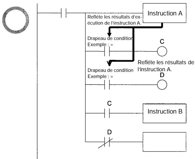
Exemple : L'exemple suivant envoie #0200 en D00200 si D00100 contient #0010 et envoie #0300 en D00300 si D00100 ne contient pas #0010.
