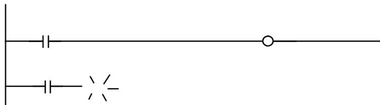
2. Les bits de sortie, les temporisations, les compteurs et autres instructions de sortie ne peuvent pas être connectés directement à la barre gauche de bus. Si un éléments ci-dessus est connecté à la barre gauche de bus, une erreur de segment apparaît pendant la vérification par un périphérique de programmation (le programme peut être exécuté, mais OUT et MOV(021) ne sont pas exécutées).
