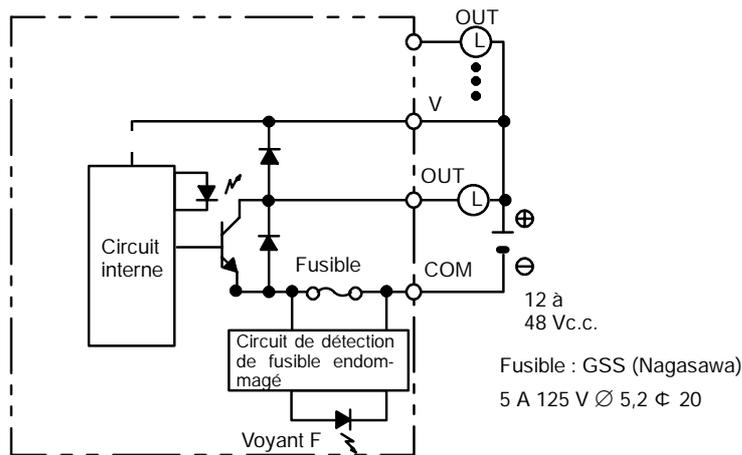
Rem. Lorsque le fusible est endommagé, le voyant F s'allume et le bit 08 passe à ON. Les bits 08 à 15 ne peuvent pas être utilisés comme bits de travail.
