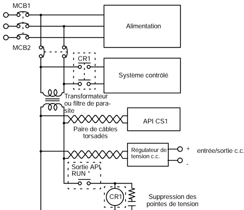
Rem. \*Cette configuration est exclusivement possible avec les Unités d'alimentation C200HW-PA204R et C200HW-PA204R. Si une Unité d'alimentation sans sortie RUN est utilisée, programmer le drapeau toujours à ON (A1) comme condition d'exécution d'un point de sortie d'une Unité de sortie.
