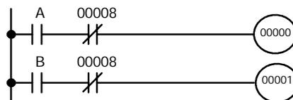
Puisque le bit de sortie d'alarme 08 recouvre les deux bits de sortie 00 et 01, ces deux sorties sont forcées à OFF dès que le bit 08 passe à ON (les bits A et B peuvent être n'importe quel autre bit requis dans le programme).
