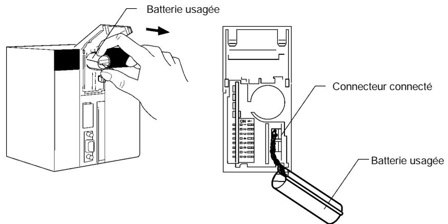
4. Insérer la batterie neuve dans le logement de la batterie, le câble et les connecteurs faisant face à l'extérieur.
