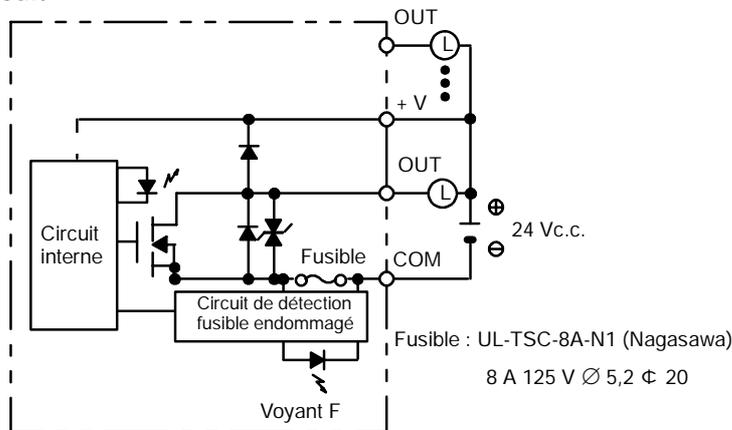
Rem. Lorsque le fusible est endommagé, le voyant F s'allume et le bit 08 passe à ON. Les bits 08 à 15 ne peuvent pas être utilisés comme bits de travail.
