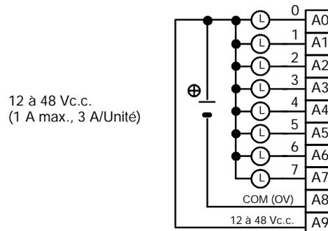
Rem. S'assurer d'alimenter A9, sinon le courant fuira par la charge à la mise à OFF de la sortie.
