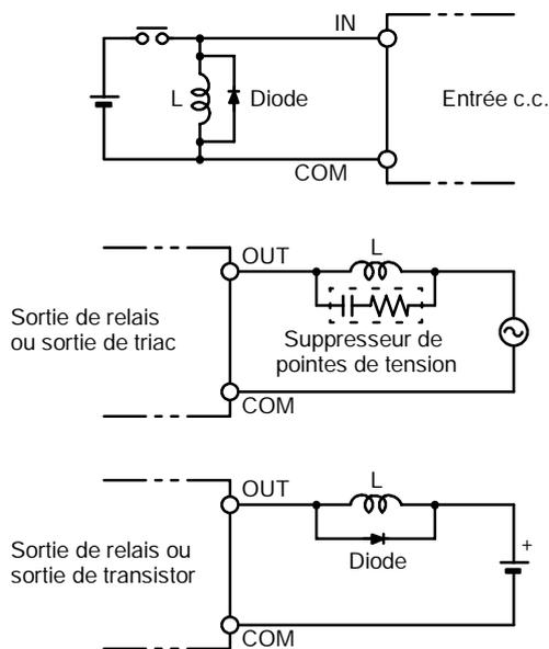
Rem. Utiliser des supprimeurs de pointes de tension et des diodes qui sont conformes aux caractéristiques suivantes.
