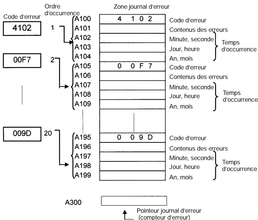
Le nombre d'enregistrements est stocké en binaire dans le pointeur du journal d'erreurs (A300). Les données dans le journal d'erreurs peuvent être effacées à partir d'un appareil de programmation.
