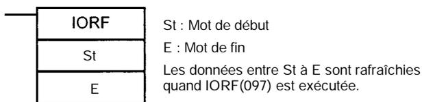
L'exemple suivant montre l'instruction IORF(097) utilisée dans le rafraîchissement de 7 mots de données d'E/S.
