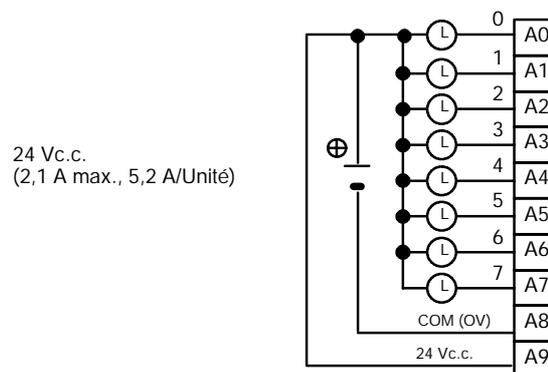
Rem. S'assurer d'alimenter A9, sinon le courant fuira par la charge à la mise à OFF de la sortie.
