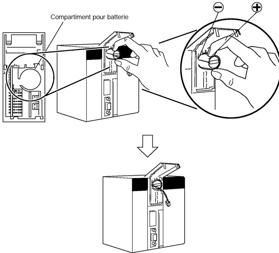
3. Connecter le connecteur de la batterie au bornier. Connecter le fil rouge en haut et le fil noir en bas du bornier. Deux borniers existent ; connecter la batterie à l'un d'eux. Peu importe si le bornier utilisé est celui d'en haut ou d'en bas.
