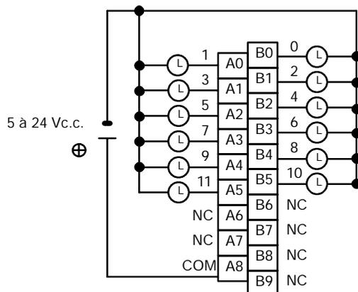
C200H-OD21A Unité de sortie à transistor (Protection de circuit de charge)
