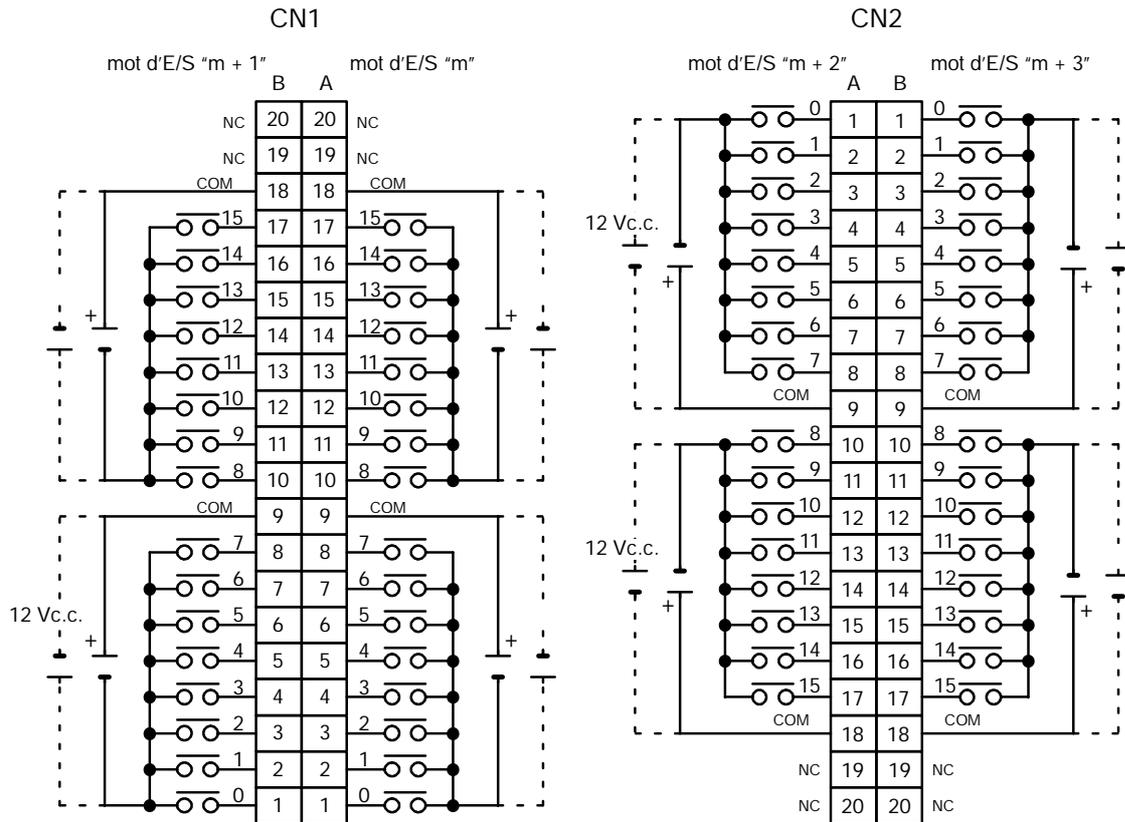
Rem. L'alimentation peut être assurée dans l'une ou l'autre polarité, mais la même polarité doit être utilisée pour toutes les bornes COM dans chaque connecteur. Connecter le câblage de l'alimentation à chaque borne COM, bien que les bornes COM dans chaque connecteur soient connectées en interne.
