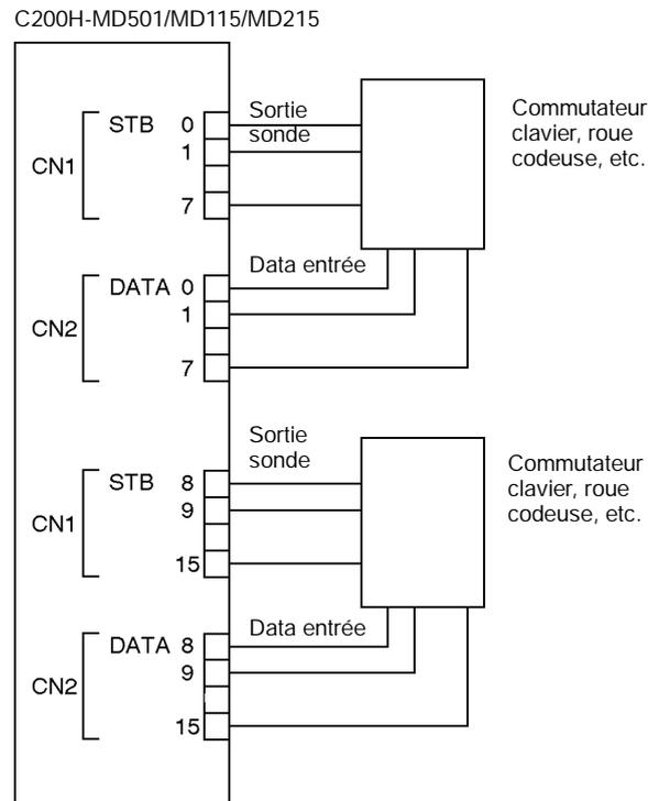
En utilisant les signaux d'échantillonnage STB 0 à 7 comme des sorties, les signaux de données DATA 0 à 7 comme des entrées, les signaux d'échantillonnage STB 8 à 15 comme des sorties, et les signaux de données DATA 8 à 15 comme des entrées, 128 bits (8 mots) peuvent être introduits à partir des boutons clavier d'entrée d'échantillons ou des molettes comme illustré sur le schéma suivant.
