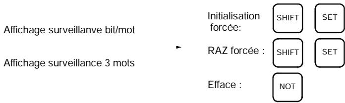
Avec CX-Programmer, cliquer sur le bit qui doit faire l'objet d'une initialisation forcée ou d'une RAZ forcée, et sélectionner ensuite Mise à 1 ou Mise à 0 sur le menu API.
