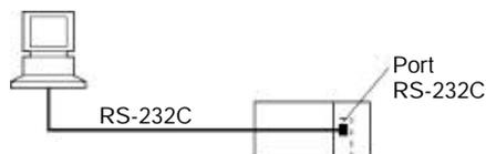
Rem. La longueur maximale du câble de connexion RS-232C est de 15 m. Cependant les particularités des communications RS-232C ne traitent pas les transmissions à 19,2 Kbps. Se reporter à la documentation concernant le périphérique connecté lors de l'utilisation de la vitesse.
