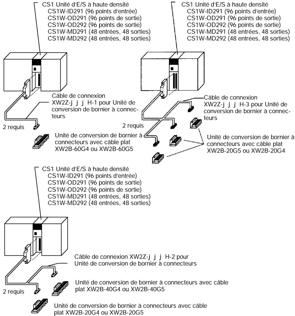
2. Connexion à une borne à relais (Il faut disposer de deux des câbles suivants et de deux Unités de conversion).
