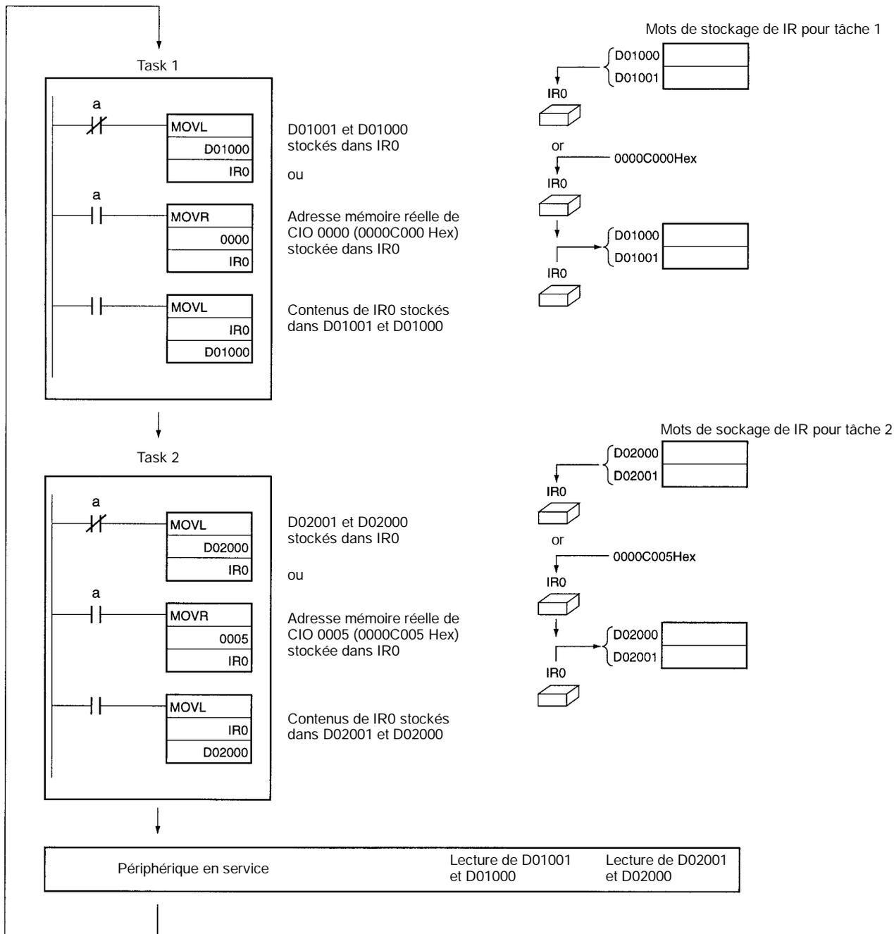
Pour partager les valeurs des registres d'index entre 2 tâches ou plus, configurer les mots de stockage pour les valeurs de registre d'index de chaque tâche aux mêmes mots. Par exemple, dans l'exemple donné ci-dessous, utiliser D01001 et D01000 pour les tâches 1 et 2.
