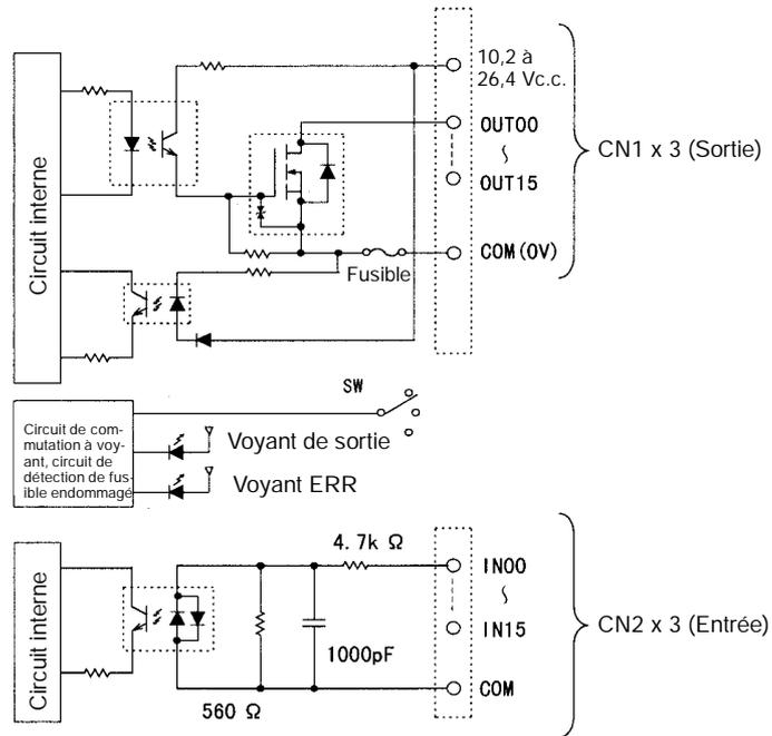
Rem. Le voyant ERR s'allume si un fusible est endommagé ou si l'alimentation externe est à OFF et le drapeau correspondant dans la zone information de l'Unité d'E/S de base (A050 à A089) passe à ON.
