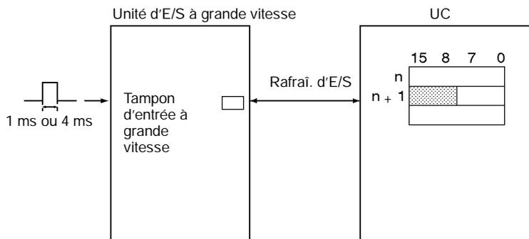
Il est également possible de rafraîchir les données de l'unité d'E/S haute densité dans le tampon d'entrée grande vitesse pendant l'exécution du programme en exécutant l'instruction IORF(097) pour l'Unité d'E/S spéciales souhaitée.
