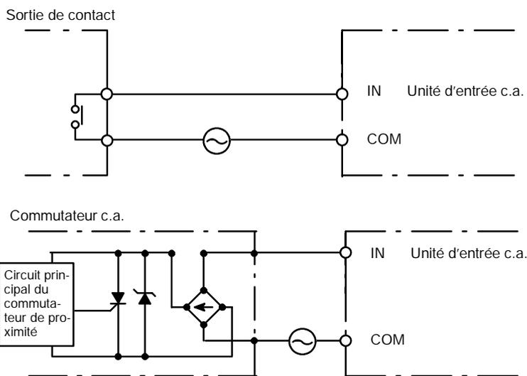
Rem. Lorsqu'un relais à contacts scellés est utilisé comme contact d'entrée d'une Unité d'entrée c.a., il faut installer un commutateur dont le courant admissible est supérieur ou égal à 1 A. Avec des relais à contacts scellés offrant des courants admissibles inférieurs, les pointes de courant peuvent provoquer une pointe de tension aux contacts
