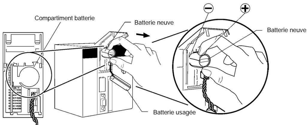
5. La batterie usagée restant connectée, mettre le connecteur de la batterie neuve dans le connecteur ouvert de l'UC. Veiller à insérer le connecteur de manière à ce que son fil rouge soit sur le dessus et son fil blanc vers le bas.
