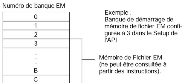
Rem. Lorsque les adresses sont désignées en programmation ou en allocation dans des Unités d'E/S spéciales C200H, "EM 0000" à "EM 6143" spécifient en réalité E0\_00000 à E0\_06143 dans l'Unité Centrale. Les autres adresses de cette zone ne peuvent pas être spécifiées.
