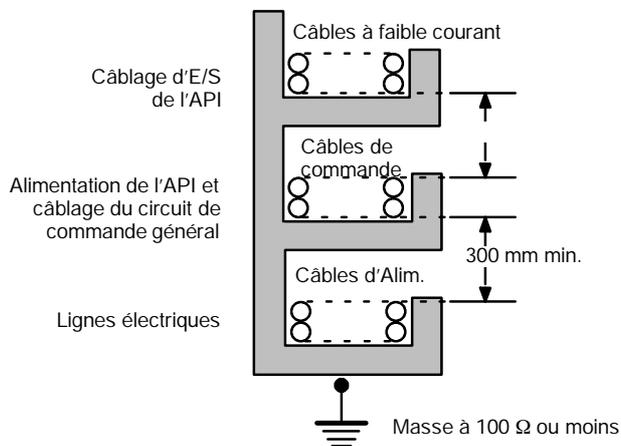
Si le câblage d'E/S et les câbles électriques doivent être mis dans le même chemin de câbles, il faut les isoler les uns des autres en utilisant de la tôle métallique mise à la masse.
