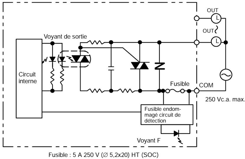
Rem. Lorsque le fusible est endommagé, le voyant F s'allume et le bit 08 passe à ON. Les bits 08 à 15 ne peuvent pas être utilisés comme bits de travail.
