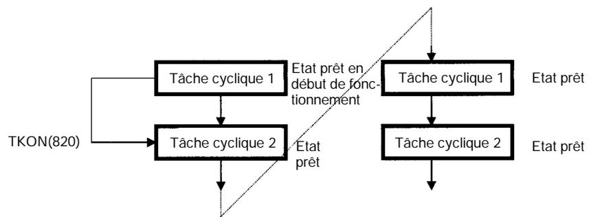
Une tâche cyclique dans l'état d'Attente maintient cet état dans les cycles suivants. La tâche doit être activée en utilisant l'instruction TKON(820) afin de passer de l'état d'Attente à l'état READY.
