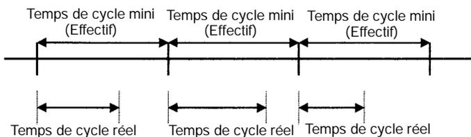
Si le temps de cycle réel est plus long que le temps de cycle minimum, le temps de cycle minimum n'est pas effectif et varie à chaque cycle.
