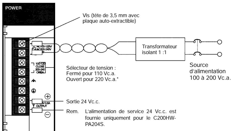
Rem. Pour éviter tout dommage, vérifier que le cavalier des bornes du sélecteur de tension a été enlevé avant de procéder à la mise sous tension en 220 Vc.a.
