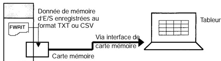
Réciproquement, des données telles que les paramétrages spéciaux d'E/S peuvent être créées avec un tableur au format TXT ou CSV, être stockées sur une carte mémoire et être lues par l'UC par FREAD(700).
