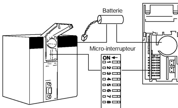
Ouverture du couvercle du port périphérique et des câbles de connexion
