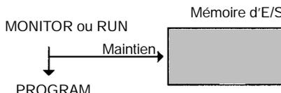
Rem. \*Les zones de mémoire d'E/S suivantes sont effacées pendant le changement de mode (PROGRAM ↔ RUN/MONITOR) sauf si le bit de maintien IOM est à ON : les zones CIO (d'E/S, de liaison données, d'Unité de bus UC CS1, de l'Unité d'E/S spéciales, des cartes internes, du SYSMAC BUS, des bornes d'E/S, du CompoBus/D et d'E/S internes), de la zone de travail, des drapeaux de fin de temporisation et des temporisations en cours (PV).
