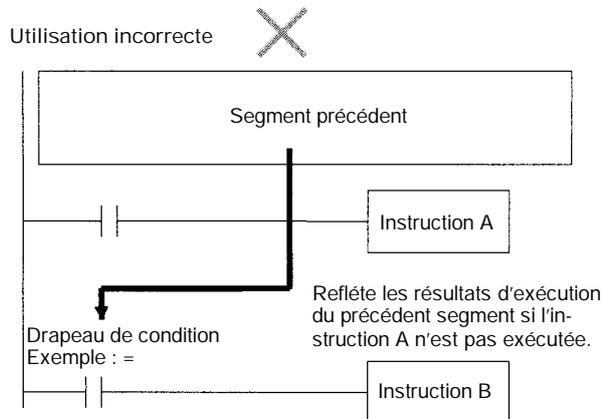
Si le drapeau de condition est connecté directement à la barre de bus gauche, l'instruction B est exécutée en fonction des résultats d'exécution du segment précédent si l'instruction A n'est pas exécutée.
