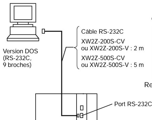
Câbles de connexion au port RS-232C
