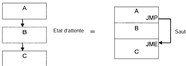
Les instructions ne sont pas exécutées dans l'état d'Attente, ainsi le temps d'exécution des instructions n'est pas augmenté. Les programmes n'ayant pas besoin d'être exécutés en permanence peuvent être transformés en tâches à état d'Attente pour réduire le temps de cycle.
