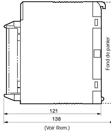
Rem. La hauteur des Unités, y compris le fond de panier, est supérieure de 5 mm sur le fond de panier de l'UC et le fond de panier d'extension CS1 (123 et 143 mm).
