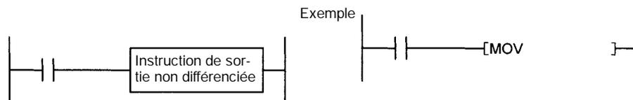
Les instructions d'entrée créent des départs logiques et les instructions intermédiaires lisent l'état du bit, font des comparaisons, testent les bits ou effectuent d'autres types de traitement à chaque cycle. Si les résultats sont à ON, le flux est sorti (c-à-d, la condition d'exécution est mise à ON).
