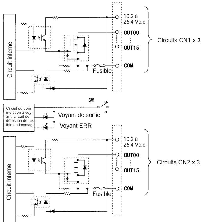
Rem. Le voyant ERR s'allume si un fusible est endommagé ou si l'alimentation externe est à OFF et le drapeau correspondant dans la zone information de l'Unité d'E/S de base (A050 à A089) passe à ON.
