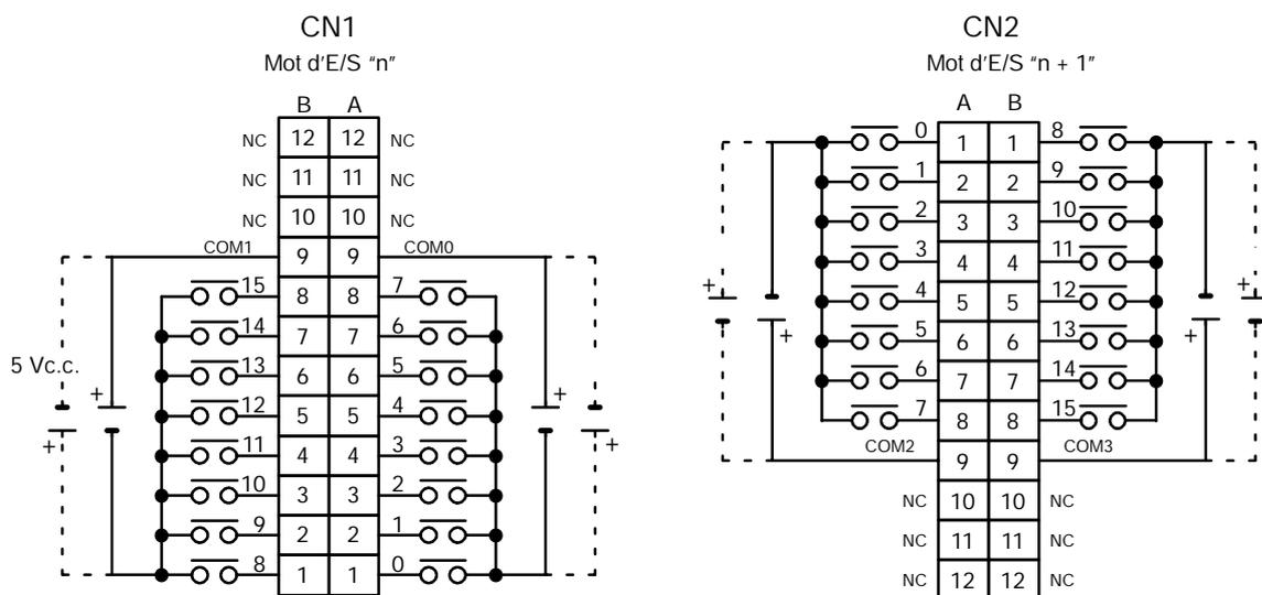
Rem. Lorsque le sélecteur 2 du micro-interrupteur DIP est à ON, les points d'entrée 08 à 15 du connecteur 2 sont des entrées à grande vitesse.
