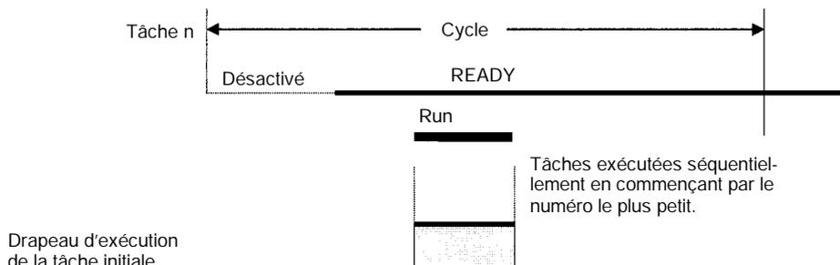
Le drapeau d'exécution de tâche initiale indique si les tâches cycliques sont exécutées pour la première fois. Ce drapeau peut ainsi être utilisé pour le traitement d'initialisation des tâches.
