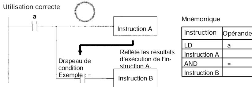
La même condition d'exécution (a) est utilisée pour les instructions A et B pour exécuter l'instruction B selon les résultats d'exécution de l'instruction A. Dans ce cas, l'instruction B sera exécutée selon le drapeau de condition seulement si l'instruction A est exécutée.
