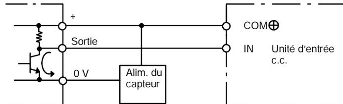
Le circuit suivant ne DOIT PAS être utilisé pour les périphériques d'E/S qui ont une sortie de tension.
