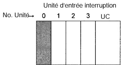
Opérande S (le deuxième opérande) de MSKS : Les 8 bits à l'extrême droite de 0008 Hex correspondent aux entrées d'interruption de l'unité d'entrée d'interruption. Les numéros d'entrée d'interruption 0 à 7 correspondent aux bits 0 à 7.
