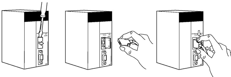
Insérer un petit tournevis à lame plate dans l'ouverture en haut du couvercle du port et tirer pour ouvrir.
