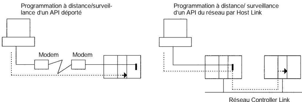
Programmation à distance/ surveillance d'un API situé après 3 niveaux de réseaux (réseau local compris) par Host Link, pouvant concerner le même ou d'autres types de réseaux.
