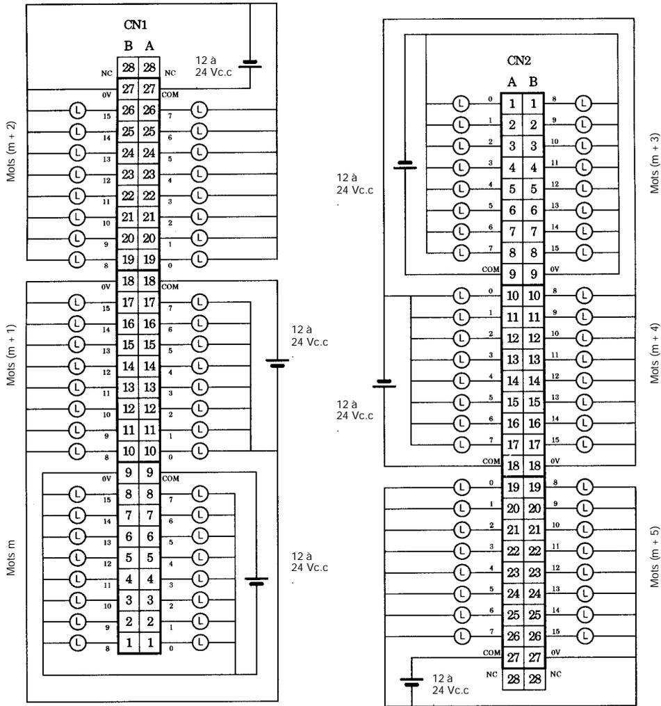
Connexions aux bornes : CS1W-MD291 Unité d'entrée 48 points/Unité de sortie 48 points, 24 Vc.c. (Sorties NPN)
