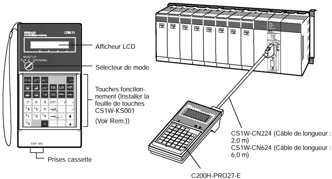
Connecter l'UC à la console de programmation avec les câbles suivants :
