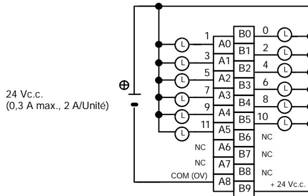
Rem. S'assurer d'alimenter B9, sinon le courant fuira par la charge à la mise à OFF de la sortie.
