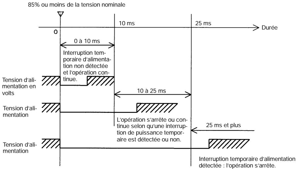
Note : L'histogramme suivant donne en exemple le cas où la durée de détection de la mise hors tension est paramétrée à 0 ms.
