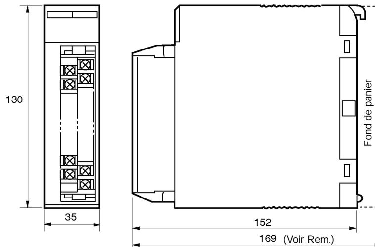
Rem. La hauteur des Unités, y compris le fond de panier, est supérieure de 5 mm sur le fond de panier de l'UC et le fond de panier d'extension CS1 (150 et 174 mm).
