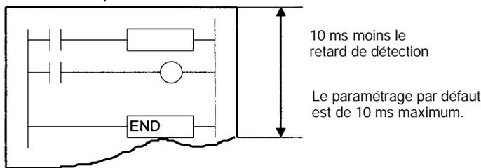
Rem. Une condition de mise hors tension est identifiée quand l'alimentation chute au-dessous de 85% de la tension nominale. Le temps nécessaire à l'exécution de la tâche d'interruption correspond au temps de détection (10 à 25 ms) plus le retard paramétré dans le setup de l'API (0 à 10 ms). Les tâches cycliques sont exécutées dans ce temps.
