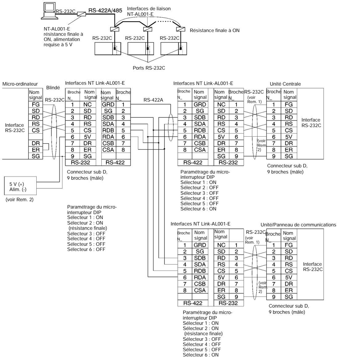
Rem. 1. Il est recommandé d'utiliser les câbles de connexion d'interface NT Link-AL001-E suivants pour connecter les interfaces NT Link-AL001-E.
