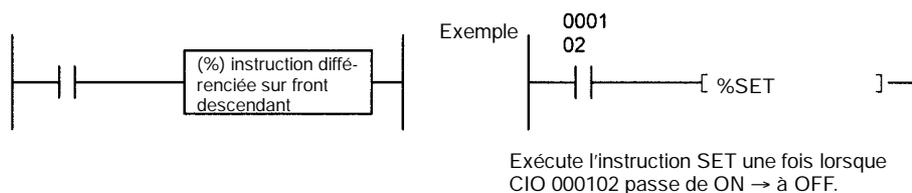
Les conditions d'exécution qui sont des sorties sont mises à ON pour un cycle et sont mises à OFF le cycle suivant.
