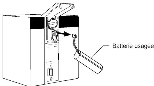
7. Enfoncer le conducteur de la batterie neuve dans le logement de la batterie et fermer le couvercle.
