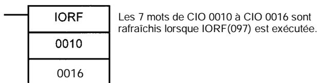
Dans un calcul et lorsqu'une réponse rapide est nécessaire pour les entrées et les sorties, utiliser IORF(097) juste avant et juste après l'instruction de calcul.
