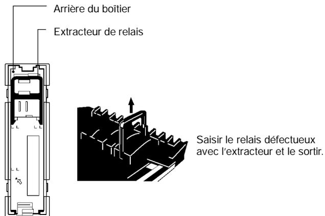
8. Pour remonter l'Unité, inverser la procédure ci-dessus et le réinstaller ensuite dans le Fonds de panier.
