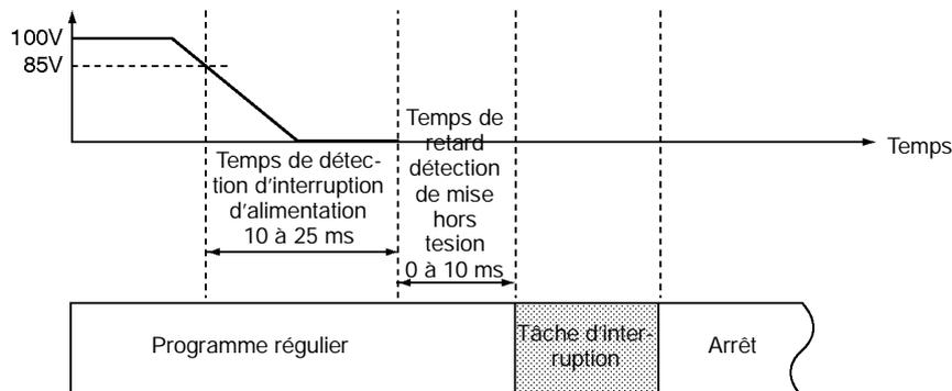
Rem. Le temps d'exécution de la tâche d'interruption pour coupure de courant doit être inférieur au temps maximal possible, soit 10 ms - temporisation de la détection des coupures de courant. Se reporter au paragraphe 11-3 Tâches d'interruption pour plus de détails sur la tâche d'interruption et au paragraphe 15-3 Fonctionnement en cas de coupure de courant pour plus de détails sur le fonctionnement de l'UC en cas de coupure du courant.
