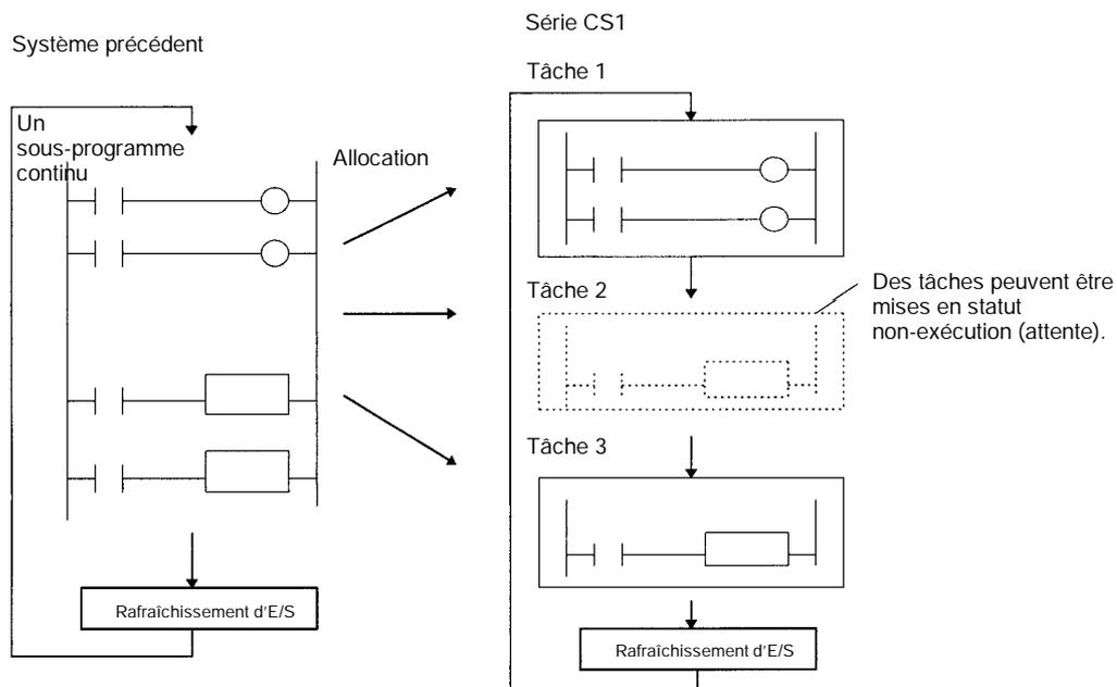
Une tâche qui a été exécutée sera exécutée dans les cycles suivants, et une tâche qui est en attente restera en attente dans les cycles suivants à moins qu'elle soit exécutée à partir d'une autre tâche.
