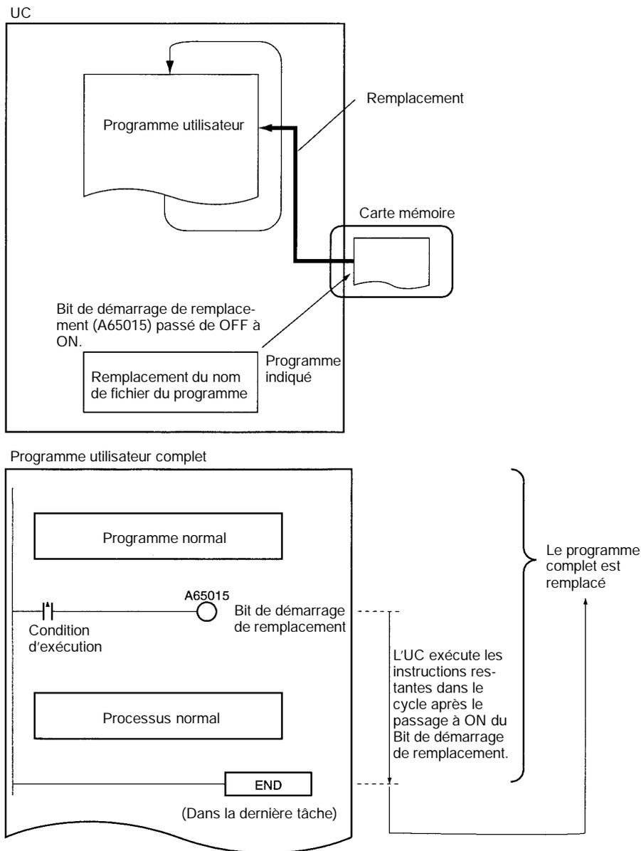
Le programme peut également être remplacé dès l'arrêt du programme (mode PROGRAM) en passant à ON le Bit de démarrage de remplacement à partir d'un périphérique de programmation.
