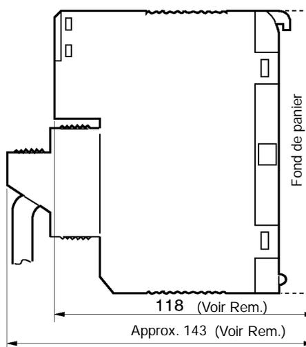
Rem. La hauteur de l'Unité, y compris le fond de panier, est supérieure de 5 mm sur le fond de panier de l'UC et le fond de panier d'extension CS1 (123 et 148 mm).
