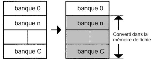
1. Régler n dans le Setup de l'API.
