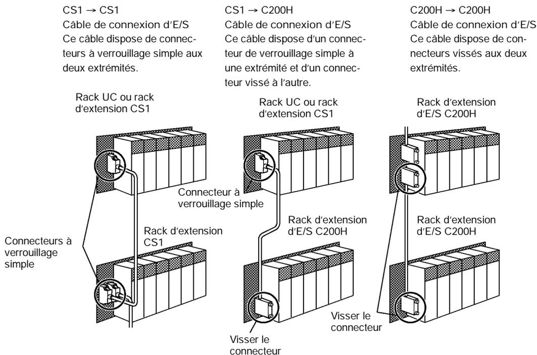
Les connecteurs n'offrent qu'une seule possibilité d'insertion ; il est impossible de les insérer à l'envers. Lors de l'insertion d'un conducteur, vérifier la qualité de l'insertion.
