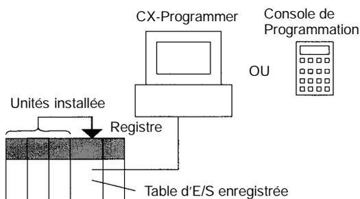
L'opération d'enregistrement de la table des E/S doit être faite en utilisant un périphérique de programmation. Si la table des E/S n'est pas enregistrée, l'Unité centrale ne pourra pas reconnaître les Unités d'E/S de base, les Unités d'E/S spéciales, les Unités Bus UC CS1, et les racks esclaves qui sont connectés à l'API.
