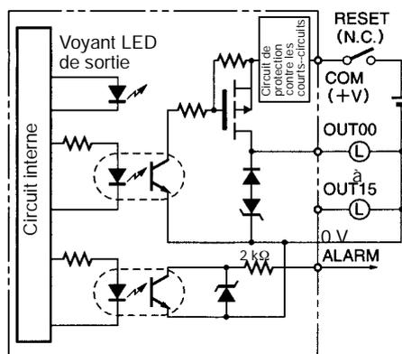
Rem. Lorsqu'une protection contre les courts-circuits/surcharge est activée, chacune des 16 sorties est commutée à OFF et la sortie ALARM devient active (niveau bas). Le problème peut être détecté extérieurement en reliant une Unité d'entrée c.c. à la sortie ALARM ou en connectant un voyant de sortie d'alarme. Il n'est pas possible de connecter en même temps l'Unité d'entrée et le voyant.
