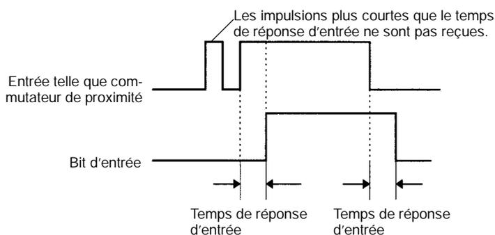
Par défaut, le temps de réponse d'entrée est de 8 ms, la plage de réglage étant comprise entre 0 et 32 ms. Si le temps de réponse est réglé sur 0 ms, il y aura un temps d'enclenchement de 20 ms max. et un temps de relâchement de 300 ms max. à cause de la temporisation des éléments internes de l'unité.
