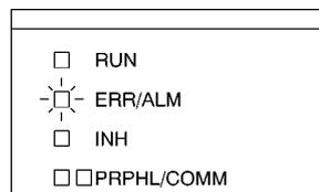
Lorsque le voyant ERR/ALM clignote, connecter une Console de programmation au port des périphériques et lire le message d'erreur. Si le message "BATT LOW" s'affiche sur la Console de programmation\* et que le drapeau erreur batterie (A40204) est à ON\*, vérifier d'abord que la batterie est bien connectée à l'UC. Si la batterie est bien connectée, il faut la remplacer dès que possible.
