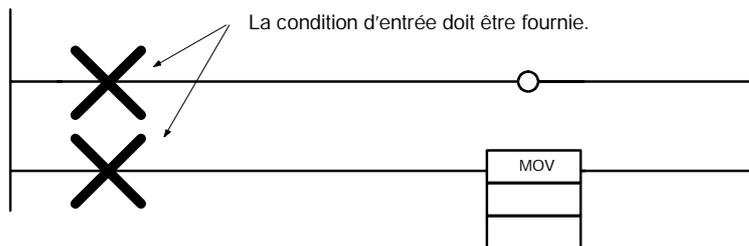
Insérer un bit de travail, une entrée non utilisée ou un drapeau à ON (drapeau toujours à ON) comme un simulacre si l'entrée doit être gardée à ON à tout moment.
