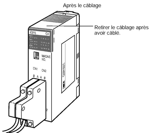
Serrer les vis de fixation du connecteur en leur appliquant un couple de 0,2 N-m.
