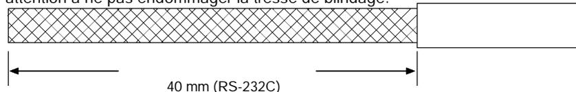
3. Utiliser des ciseaux pour dénuder les brins en laissant 10 mm de tresse de blindage intacte.
