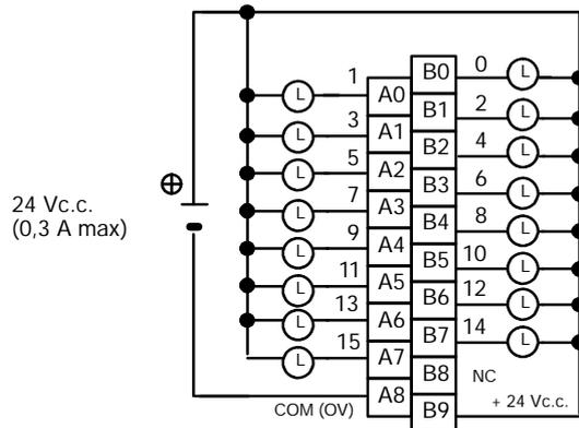
Rem. S'assurer d'alimenter B9, sinon le courant fuira par la charge à la mise à OFF de la sortie.
