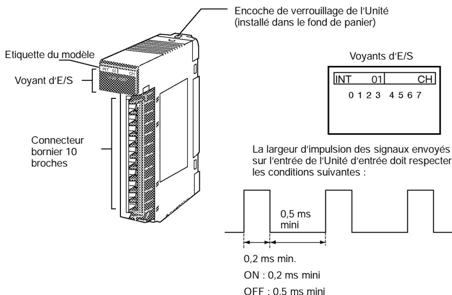
Rem. L'Unité d'entrée d'interruption doit être montée sur le rack de l'UC. Si elle est montée sur un rack d'extension, les réglages d'interruption sont impossibles.
