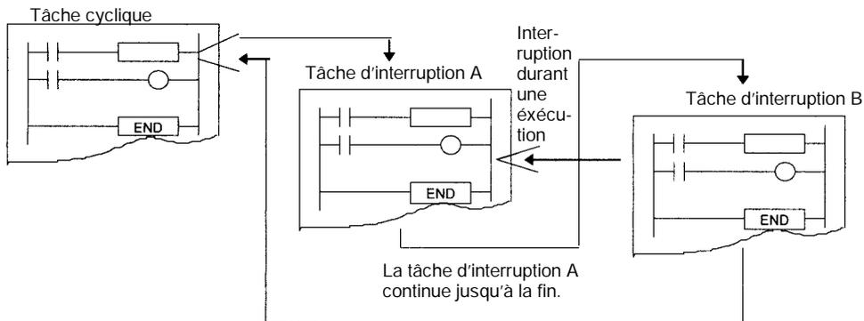
Rem. Si une tâche d'interruption d'E/S ne doit pas être sauvée et exécutée pendant qu'une autre tâche d'interruption est en cours, exécuter l'instruction CLI (CLEAR INTERRUPT) pour effacer le numéro d'interruption sauvegardé en interne. Les interruptions programmées et les interruptions externes ne peuvent pas être annulées.
