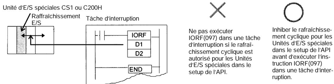
Rem. Le bit à l'extrême gauche d'A426 (erreur de tâche d'interruption, numéro de tâche) peut être utilisé pour déterminer quelle erreur des tâches d'interruption ci-dessus s'est produite (bit 15 : 10 ms ou erreur plus élevée d'exécution si à 0, erreur de rafraîchissement multiple si à 1)
