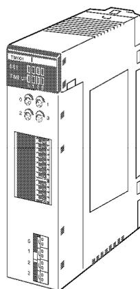
L'Unité de temporisation analogique est classée comme une Unité d'E/S de base et un mot lui est affecté dans la zone des E/S. Le mot (16 bits) affecté à l'Unité est utilisé pour l'entrée de démarrage, l'entrée de pause, la sortie de temporisation et le transfert avec l'UC des quatre temporisateurs.
