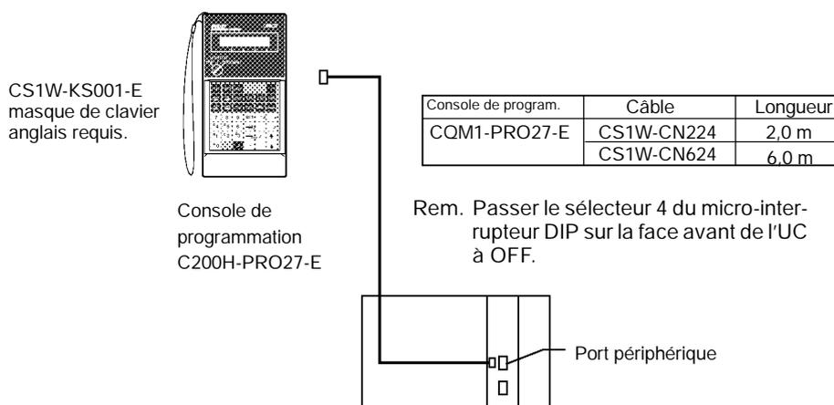
Rem. Lorsqu'un terminal opérateur programme (TOP) est connecté au port RS-232C et que les fonctions de la console de programmation sont utilisées, ne pas connecter la console de programmation en même temps.
