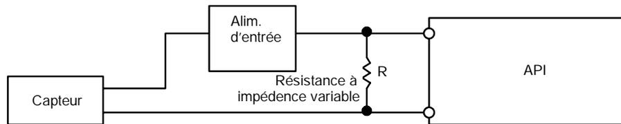
Les formules suivantes permettent de déterminer la résistance (R) et la puissance nominale (W) de la résistance à impédance variable :
