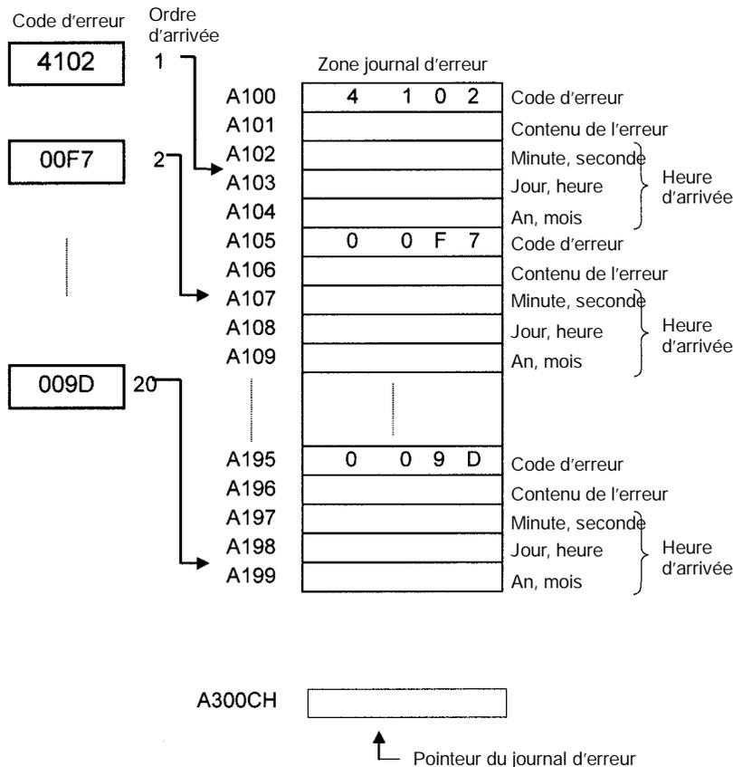
Le nombre d'enregistrements est rangé dans le pointeur du journal d'erreur (A300). Le pointeur n'est pas incrémenté après l'apparition de 20 erreurs.
