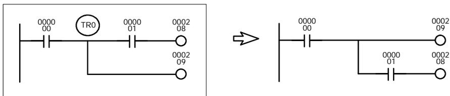
Dans l'exemple ci-dessous, utiliser TR0 pour stocker la condition au point de branchement ou pour réécrire les segments.
