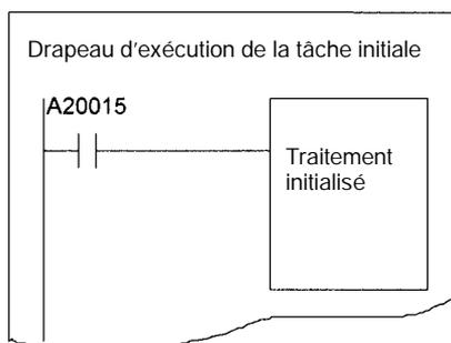
Rem. Lorsqu'une tâche cyclique en état d'Attente passe en état READY par l'instruction TKON(820), ceci n'est pas considéré comme une première exécution et le drapeau d'exécution de tâche initiale (20015) ne passe pas à ON. Le drapeau d'exécution de tâche initiale (20015) ne passe pas à ON également si une tâche cyclique passe de l'état Désactivé à Run ou si elle est mise dans l'état d'Attente par une autre tâche par l'instruction TKOF(821) avant l'obtention de l'autorisation d'exécution.
