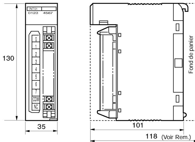
Rem. La hauteur de l'Unité, y compris le fond de panier, est supérieure de 5 mm sur le fond de panier de l'UC et le fond de panier d'extension CS1 (123 mm).
