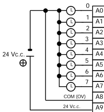
Rem. S'assurer d'alimenter A9, sinon le courant fuira par la charge à la mise à OFF de la sortie.
