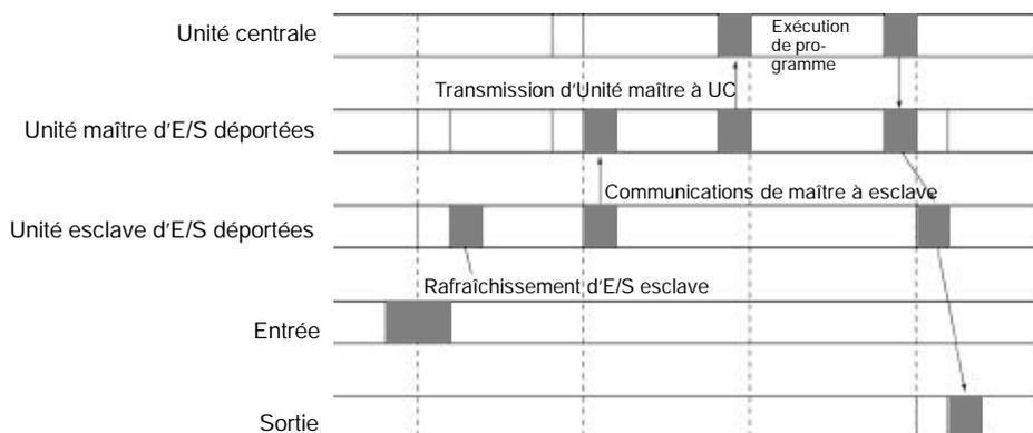
Temps de transmission d'E/S déportées = (Temps de transmission d' esclave d'E/S déportées par esclave + temps de transmission de la borne d'E/S) 2
