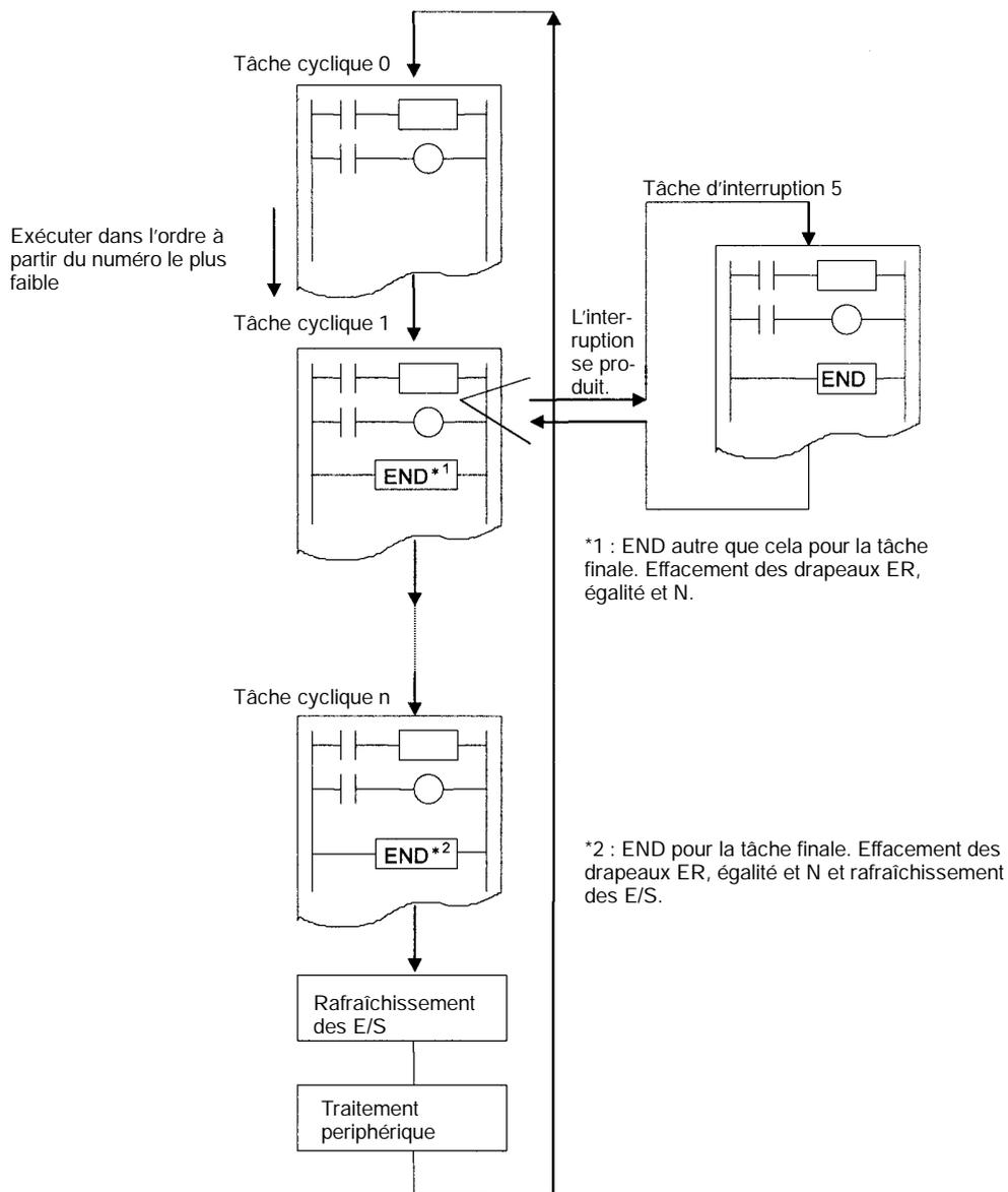
Rem. Tous les drapeaux de condition (ER, CY, égalité, AER, etc.) et les conditions d'instruction (verrouillage ON, etc.) sont effacés au début d'une tâche. Par conséquent, les drapeaux de condition ne peuvent pas être lus et les instructions INTERLOCK/INTERLOCK CLEAR (IL/ILC), les instructions JUMP/JUMP END (JMP/JME), ou les instructions SUBROUTINE CALL/SUBROUTINE ENTRY (SBS/SBN) ne peuvent pas être dédoublées entre deux tâches.
