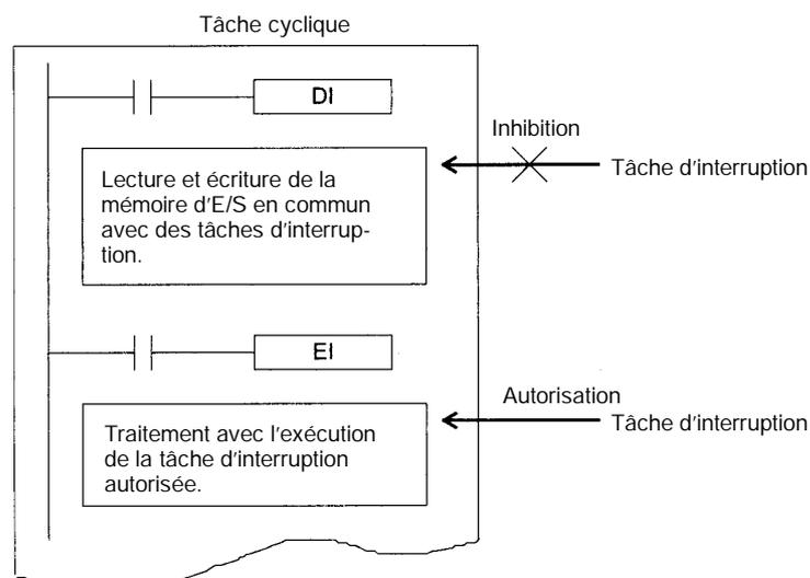
Des problèmes peuvent se produire avec la simultanéité de données même si DI(693) et EI(694) sont utilisées pour inhiber des tâches d'interruption pendant
