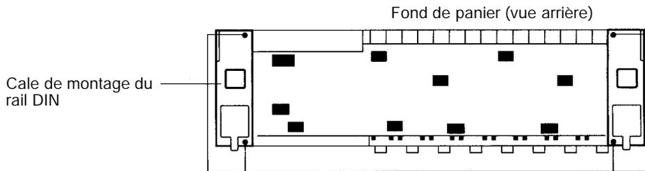
Il y a deux vis de montage du fond de panier sur les côtés gauche et droit du fond de panier. Utiliser ces vis pour fixer la cale de montage du rail DIN au fond de panier (serrer à un couple de 0,9 Nm).
