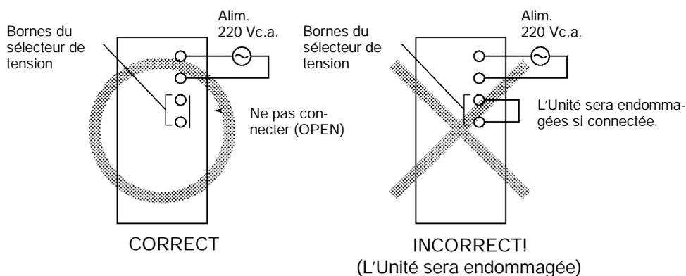
Rem. Si le système est alimenté en 110 Vc.a. et que le cavalier a été enlevé pour sélectionner une tension d'alimentation de 220 Vc.a., l'Unité ne fonctionnera pas parce que la tension d'alimentation sera inférieure au niveau minimum requis (85 %).
