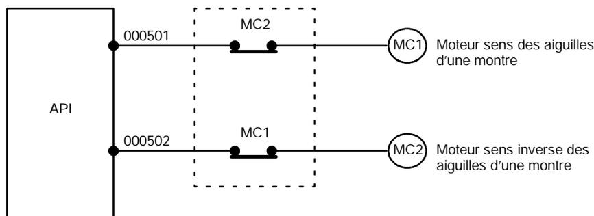
Ce circuit interdit aux sorties MC1 et MC2 d'être à ON simultanément, même si les CIO 000500 et CIO 000501 sont tous deux à ON ; ainsi, le moteur est protégé contre une programmation incorrecte ou un dysfonctionnement de l'API.
