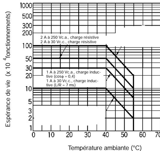
Rem. 1. Si l'Unité de sortie à contact est installée dans un panneau, la température à l'intérieur du panneau représente la température ambiante.
