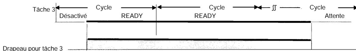
Rem. Les drapeaux de tâche sont uniquement utilisés avec des tâches cycliques et non avec des tâches d'interruption. Avec une tâche d'interruption, A44115 passe à ON si une tâche d'interruption est exécutée après le démarrage du fonctionnement. Le numéro de la tâche d'interruption, ayant nécessité le maximum de temps de traitement, est stocké dans deux digits hexadécimaux A44100 à A44107.
