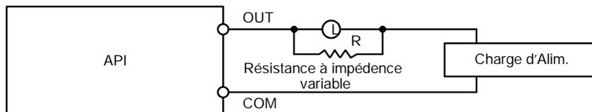
Les formules suivantes permettent de calculer la résistance et la caractéristique nominale de la résistance à impédence variable.
