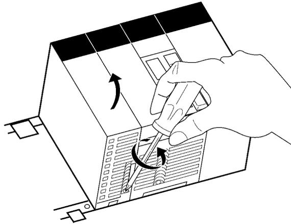
Pour déposer une Unité du Groupe B, appuyer sur le levier de verrouillage avec un outil, par exemple un tournevis, tourner l'Unité vers le haut et la déposer.
