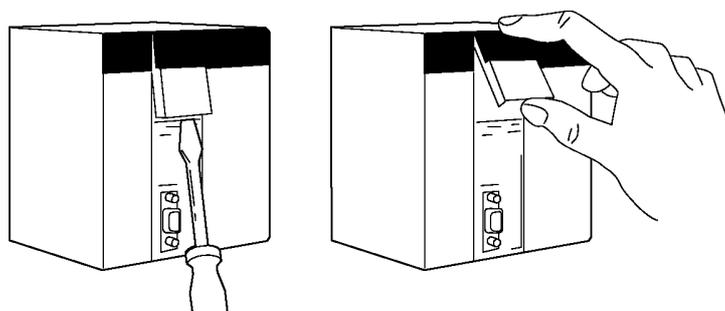
Insérer un petit tournevis à lame plate dans l'ouverture en bas du couvercle du compartiment batterie et soulever le couvercle.
