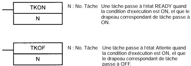
Les instructions TASK ON et TASK OFF peuvent être utilisées pour changer à n'importe quel moment toute tâche cyclique de l'état READY à l'état Attente. Une tâche cyclique dans l'état READY maintient cet état dans les cycles suivants, et une tâche cyclique dans l'état d'Attente maintient cet état dans les cycles suivants.
