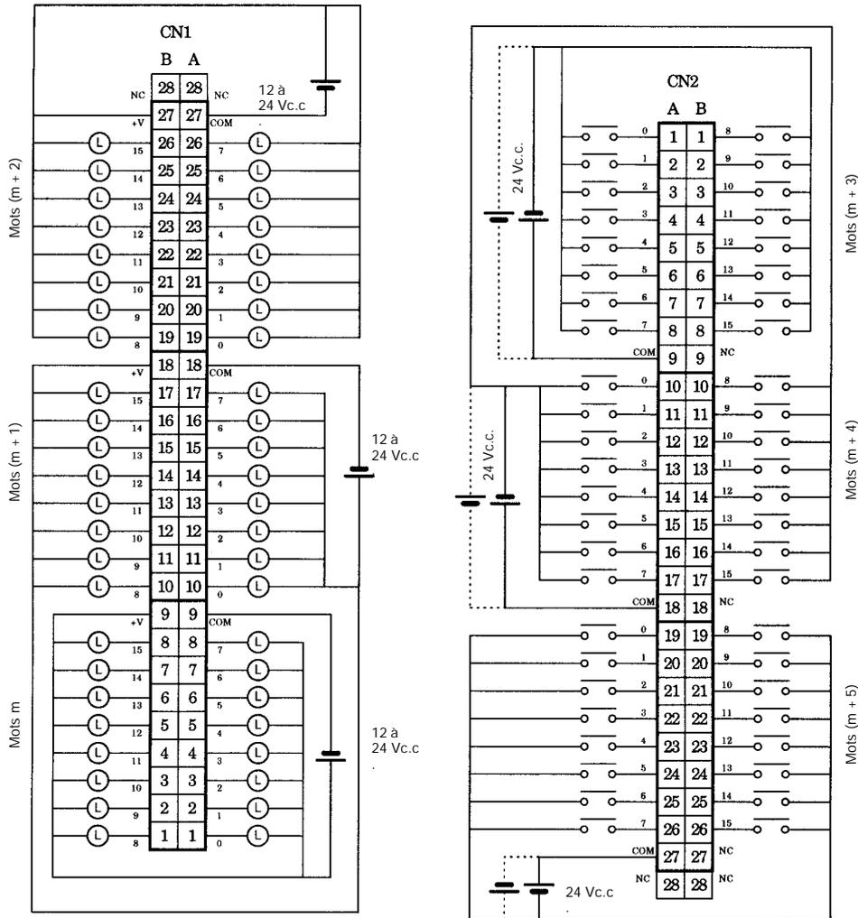
Connexions aux bornes : CS1W-MD292 Unité d'entrée 48 points/Unité de sortie 48 points à transistor, 24 Vc.c. (Sorties PNP)
