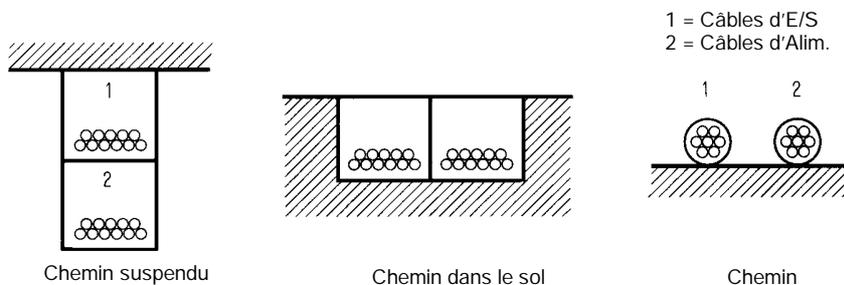
Si le câblage des E/S et le câblage de l'alimentation doivent être mis dans le même chemin de câbles, utiliser un câble blindé et, pour réduire les parasites, relier le blindage à la borne GR.
