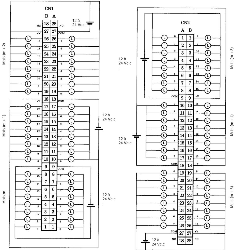
Connexions aux bornes : CS1W-OD292 Unité de sortie à transistor (Sorties NPN) 96 points, 24 Vc.c.
