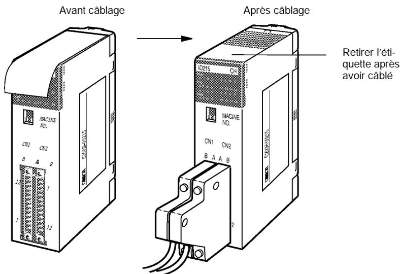
3. Lorsque des connecteurs à souder sont utilisés, veiller à ne pas provoquer accidentellement une mise en court-circuit de bornes adjacentes. Couvrir la soudure avec un manchon thermo-rétractable.
