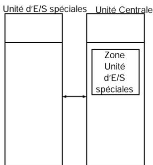
Ces paramétrage déterminent si oui ou non les données sont échangées avec les 10 mots alloués à chaque unité d'E/S spéciales dans la Zone unité d'E/S spéciales pendant un rafraîchissement des E/S cycliques.
