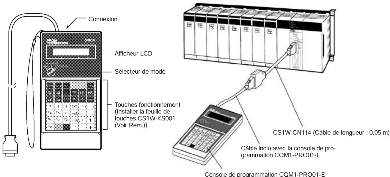
Connecter l'UC à la console de programmation avec le câble suivant :
