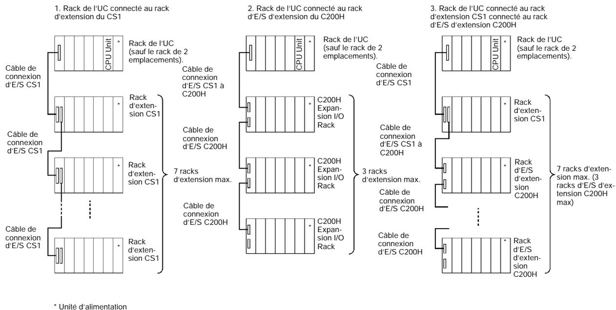
Rem. Les racks d'extension CS1 doivent être connectés avant que les racks d'E/S d'extension C200H le soient. La configuration suivante n'est pas autorisée.
