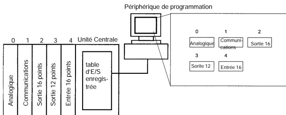
Le drapeau d'erreur de vérification d'E/S (A40209) est mis à ON si les modèles et les localisations des unités installées sur l'API (Rack de l'UC, racks d'E/S d'extension et racks esclave) ne sont pas égales aux informations de la table d'E/S enregistrée.
