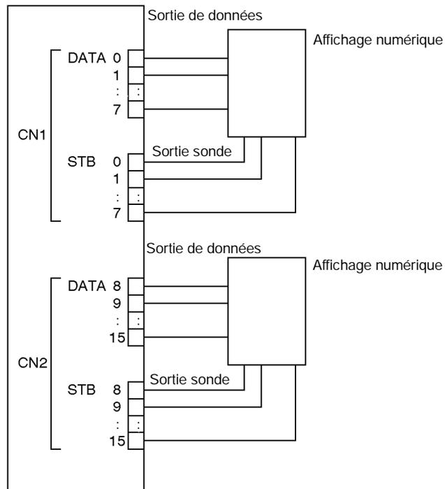
En combinant les signaux de données (DATA 0 à 7 et DATA 8 à 15) aux signaux d'échantillonnage (STB 0 à 7/ STB 8 à 15), 128 bits (8 mots) peuvent s'afficher sur un écran numérique comme illustré sur le schéma suivant.
