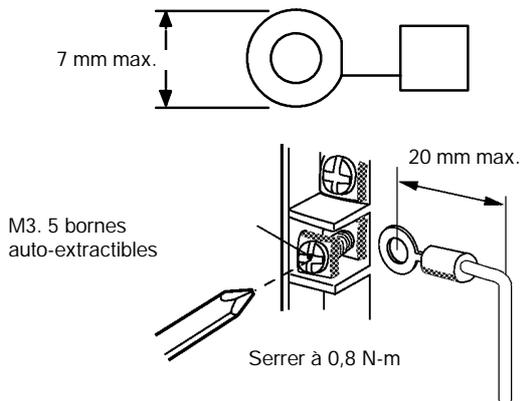
**!** Attention Pour serrer les vis du bornier de l'alimentation CA, appliquer un couple de 0,8 N • m. Les vis mal serrées peuvent provoquer un court-circuit, un dysfonctionnement ou un incendie.
