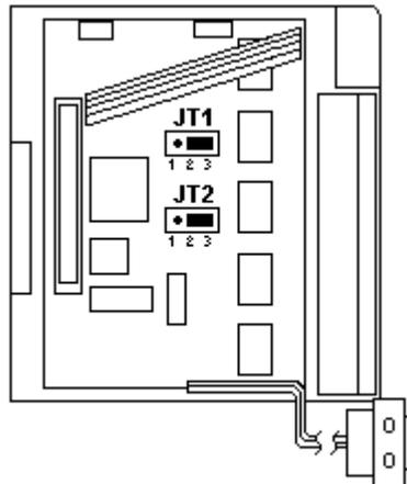
Pour limiter la voie 1 entre 0 et 10v, placer le cavalier JT1 entre 1 et 2 (idem pour la voie 2 avec JT2). Dans ce cas, une valeur négative donnera zéro volt en sortie.
