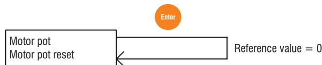
Sélectionner le paramètre **Motor pot reset** dans le sous-menu “Motor pot”.
