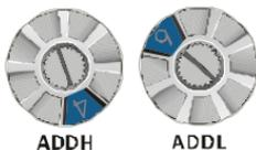
L'EXP-PDP-ADV20/50 a deux sélecteurs rotatifs permettant à l'utilisateur de sélectionner l'adresse PROFIBUS. La valeur spécifiée au moyen de ces 2 sélecteurs d'adresse, ADDH et ADDL, est en format HEX. ADDH définit les 4 bits supérieurs, et ADDL les 4 bits inférieurs de l'adresse PROFIBUS.
