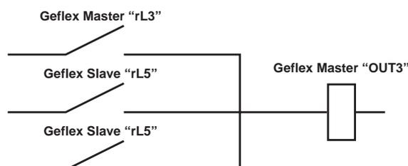
La sortie "OUT3" peut fonctionner en modalité indépendante de l'état des Geflex Esclaves, en configurant le paramètre "rL5" de chaque Geflex Esclave présent sur 128.
