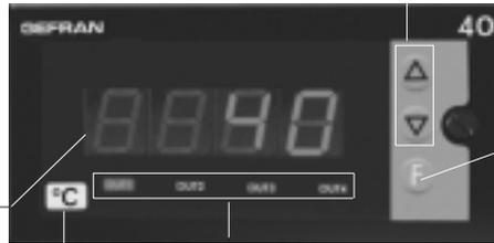
**Affichage de la mesure (PV):** indication de message HI ou Lo (hors échelle positif ou négatif) • Indication de rupture (br) ou court-circuit (Er) du capteur • Affichage des messages de configuration et de calibration.
