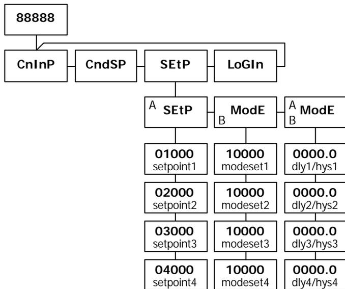
Sur le diagramme, le module **SetP** de programmation de l'option de setpoints avec 3 menus:
