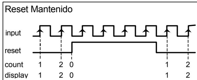
Une fois le mode reset sélectionné par le CLAVIER, on peut inhiber la TOUCHE RESET indépendamment pour chaque variable du compteur (PROCESS, BATCH ou TOTAL), dans la routine de programmation du blocage par software (voir pages. 47 et 48).
