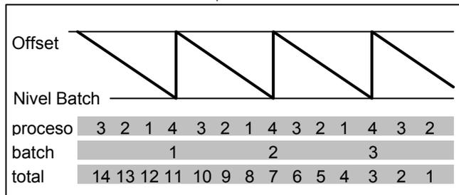
Pour les compteurs bidirectionnels, si le niveau batch est au dessus de l'offset, la fonction batch se réalisera en dépassant sur le compteur partiel le dit niveau en sens ascendant. Au contraire, si le niveau batch est en dessous de l'offset, la fonction batch se réalisera en atteignant sur le compteur partiel le dit niveau en sens descendant.
