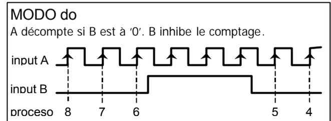
**Dans les modes unidirectionnels, lorsqu'il n'est pas nécessaire d'utiliser le signal d'inhibition de comptage, l'entrée B se connectera au négatif commun, (PIN 4 de CN3), pour éviter son activation par des perturbations externes ou influence du signal de comptage sur A.**
