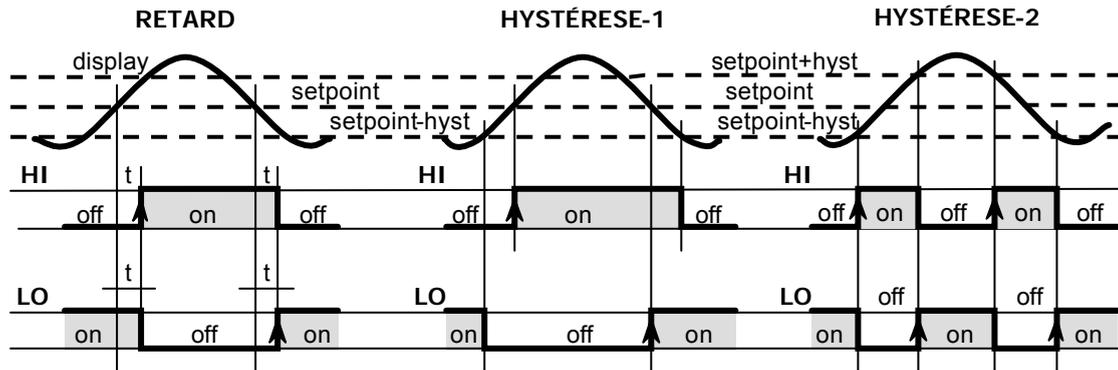
(▲ : Flanc d'activation de l'alarme où s'enclavent les sorties des setpoints en mode latch)
