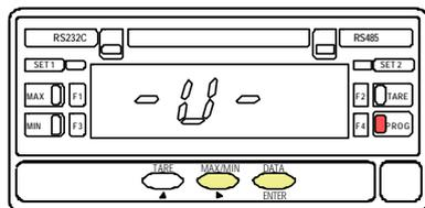
Le type d'entrée programmé antérieurement est donné par la fig. 13.2 (par exemple ici **-U-** pour entrée tension).
