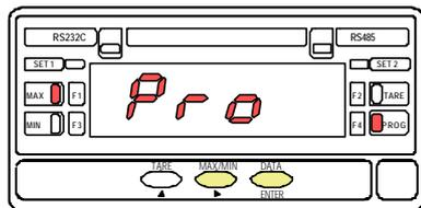
La fig. 13.1 indique que l'appareil est prêt à accéder au menu de configuration de l'entrée (leds F1 et PROG activées). Confirmer par **ENTER**.
