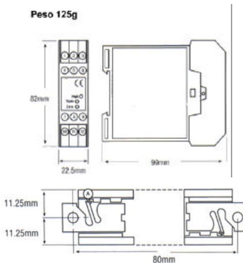
KOS1100 doit être placé dans une enceinte qui garantit une protection par rapport à l'ambiance extérieure et assurant une température et une humidité compatibles avec les limites de travail. Il est recommandé aussi d'éloigner les sources de bruit tels que transformateurs et contacteurs.
