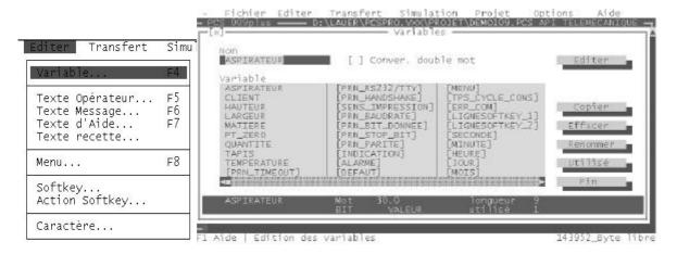
Une variable est définie par un nom de 16 caractères maximum. Les variables marquées par des [ ] sont des variables internes. Un ensemble de commandes permet de "copier", "effacer", "renommer" les variables. La commande "utilisé" réalise une liste croisée de la variable sélectionnée.
