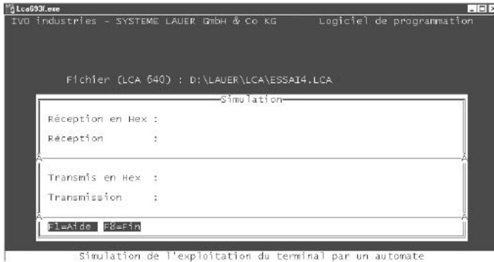
Cette fenêtre permet, dans la ligne TRANSMISSION d'envoyer les séquences et les codes spécifiques pour l'affichage des messages ; la ligne RECEPTION permet de visualiser les codes ou séquences de codes programmés pour les différentes touches de fonction. Cette ligne est uniquement valable pour l'afficheur LCA 640.
