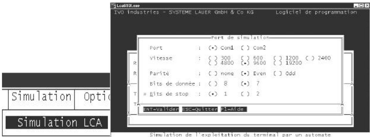
Cette fenêtre permet de configurer la liaison série pour le mode simulation. Cette configuration doit être identique à celle réalisé lors de la compilation et du transfert du programme.
