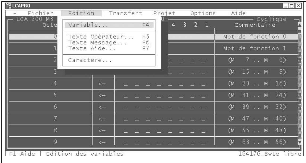
4° Transmettre le fichier compilé dans l'afficheur LCA 200 à l'aide de la fenêtre **[Transfert]**.
