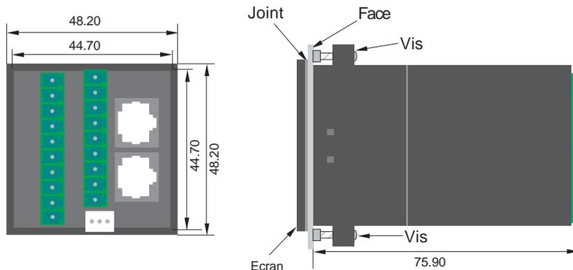
Serrer la vis de montage uniformément avec un couple de serrage compris entre 0.6 et 0.7 Nm pour garantir la résistance à l'eau et à la poussière. Vérifier que le panneau n'est pas sale et abîmé et qu'il est fixé solidement à l'unité.
