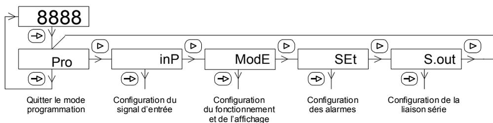
Le module de configuration liaison série n'est accessible que si le tachymètre est équipé de l'option correspondante.
