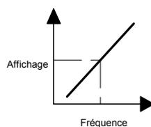
En **direct**, la valeur d'affichage augmente avec la fréquence d'entrée, à utiliser pour afficher une cadence de production horaire par exemple.
