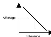
En **inverse**, la valeur d'affichage diminue avec la fréquence d'entrée, à utiliser pour afficher un temps de passage dans un tunnel de cuisson par exemple.
