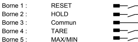
L'utilisation des entrées électriques RESET, et TARE est identique à l'utilisation faite par les touches du clavier ; quant à l'entrée HOLD, elle permet de figer temporairement l'affichage. Ces entrées sont optocouplées et le niveau logique actif est 0.
