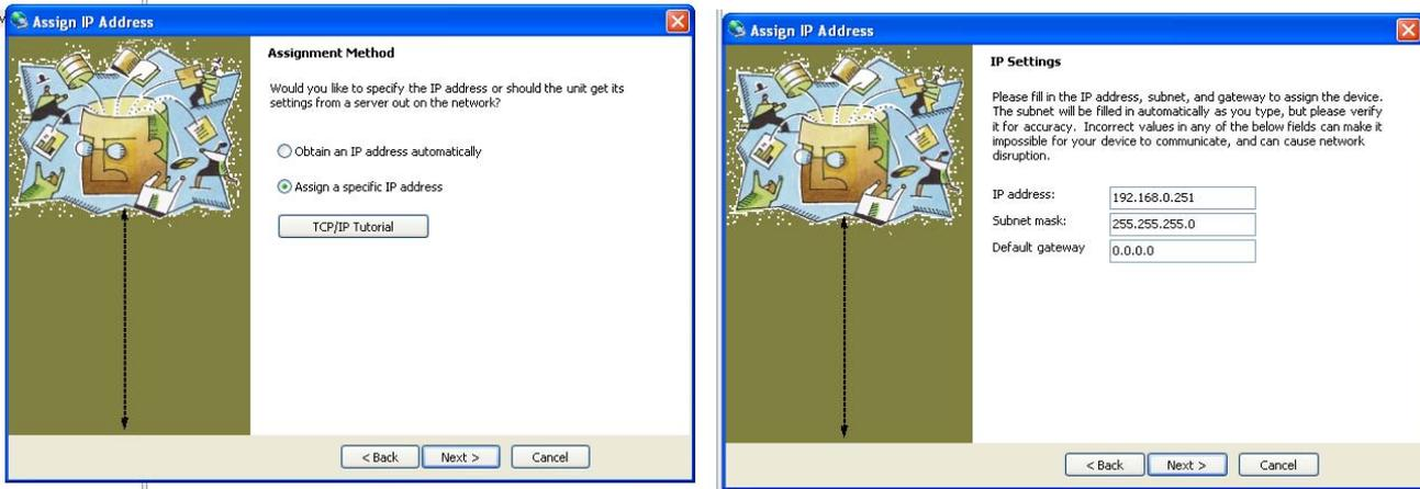
Suivre les instructions de programmation, puis cliquer sur « Assign » pour affecter la nouvelle IP à l'afficheur. Dans l'exemple ci-dessus l'on a affecté à l'afficheur l'adresse IP 192.168.0.251 et le masque de sous-réseau 255.255.255.0.
