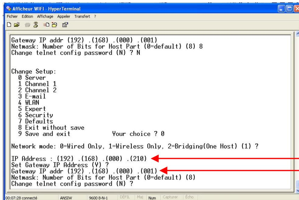
Programmer les paramètres du menu 0 comme décrit ci-dessus en indiquant l'adresse IP à affecter à l'afficheur et, si nécessaire, l'adresse IP de la passerelle réseau.
