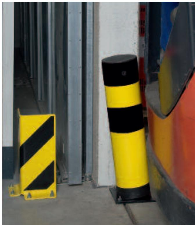
Le poteau de protection astucieux: Le ressort intégré en spirale et le tampon en PU absorbent même les forces élevées de choc. Minimise les détériorations au niveau de la borne ou sur le véhicule (chariot élévateur, camion). La borne s'incline jusqu'à 25° max. et se replace automatiquement dans sa position initiale.
