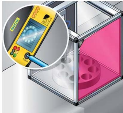
Une séquence de pressions sur la touche Teach suffit pour lancer l'apprentissage. Le capteur enregistre la position de la bande réfléchissante : la zone à protéger est définie.
