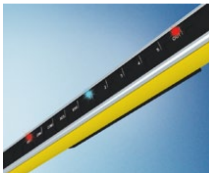
Les LED bleues facilitent l'alignement : plus il y a de LED allumées, meilleur est l'alignement.
