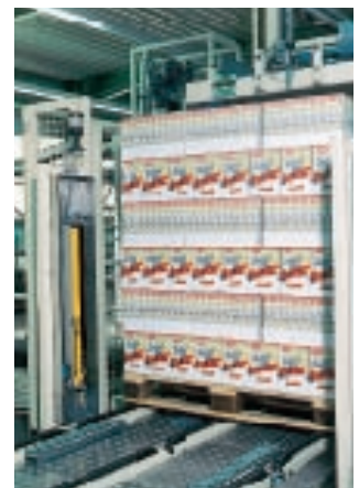
MSL avec inhibition sur un palettiseur
