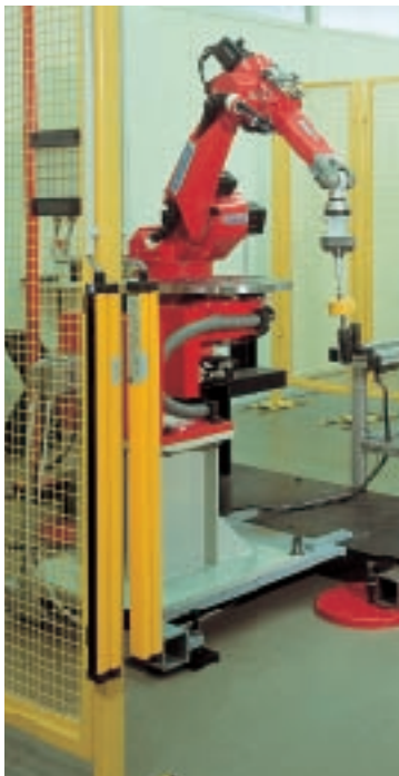
MSL interdisant l'accès à un robot
