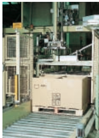
MSL avec inhibition monté sur une machine d'emballage
