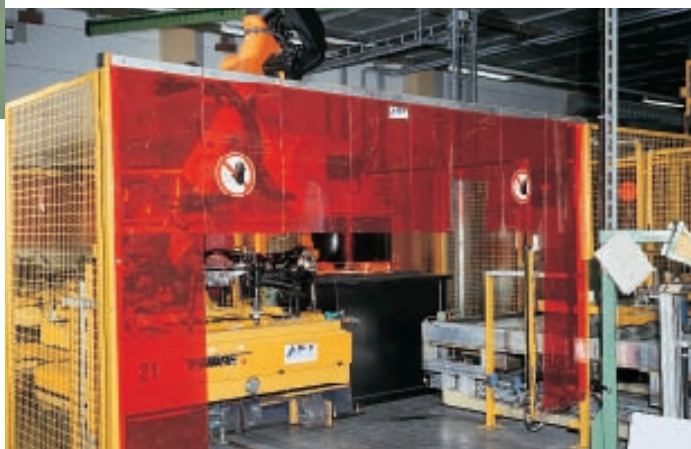
MSL avec inhibition dans un système de convoyage de l'industrie automobile
