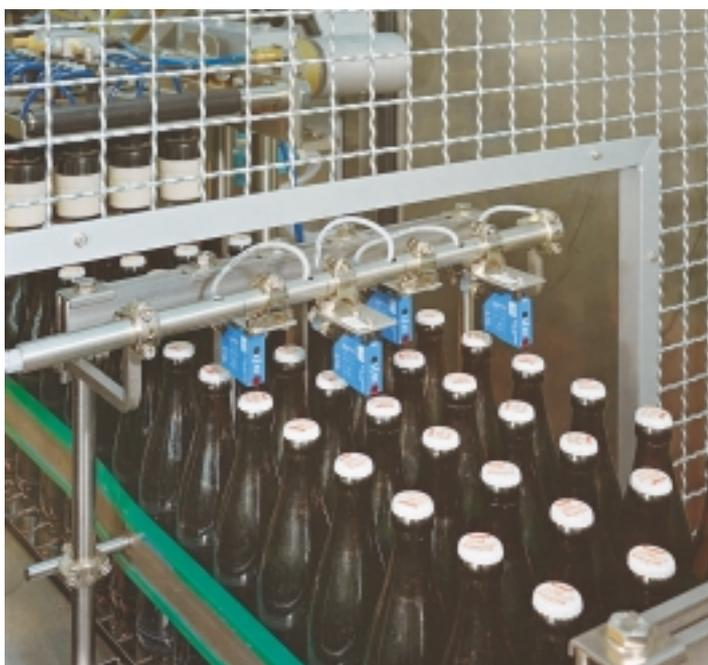
▲ Pack de six ou pack de cinq : les détecteurs réflex WT 12-2 à élimination d'arrière-plan détectent les espaces vides dans le défilement des bouteilles sur une installation de chargement automatique.
