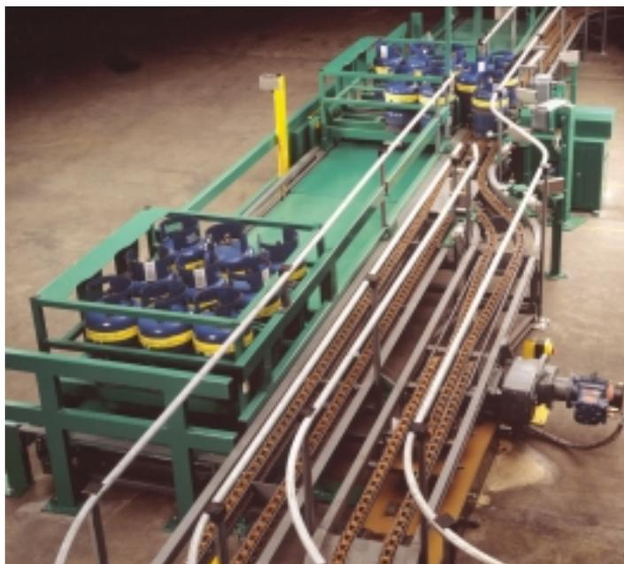
▲ Zone explosive 0 : carrousel de remplissage automatique des bouteilles de gaz
