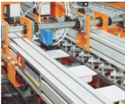
▲ L'apposition d'un repère fluorescent lors du contrôle de qualité permet de trier automatiquement les dalles par classe de qualité à l'aide d'un détecteur de luminescence.
