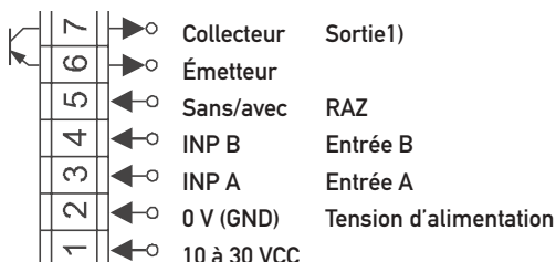
Schéma de raccordement CXG 23/...27/...28
