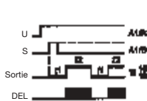
Démarrage par temps de pause avec impulsion de commande (33)
