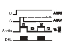
Démarrage par temps de travail avec impulsion de commande (34)
