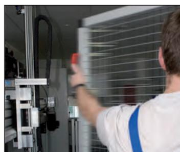
Le système de retenue est activé à l'arrêt de la machine, l'axe Z est ainsi protégé contre l'effondrement vertical. La zone de sécurité est accessible sans danger.
