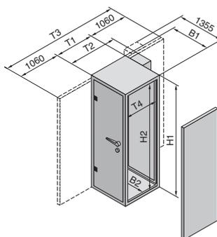
Le coffre-fort modulaire Extend offre un maximum de sécurité et assure une protection efficace contre les nuisances et méfaits d'ordre physique. Disponible en différentes tailles, le coffre-fort modulaire vous permet de choisir librement l'équipement : portes, systèmes de fermeture, systèmes d'isolation pour les câbles ainsi que différentes solutions de climatisation.
