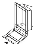
Possibilité d'ajouter un coffret-clavier VIP 6000, numéro d'identification voir page 28. La largeur de la face avant du coffret-clavier est définie en fonction de la largeur B1 du coffret AE - 54 mm. L'assemblage des coffrets se fait par jonctions de cadres, livrées avec le coffret-clavier.
