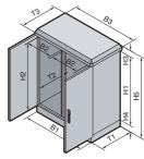
**Matériau :**Corps de l'armoire, toit et portes : aluminium, AIMg3 de 2,0 mm aluminium, AIMg3 de 3,0 mm
