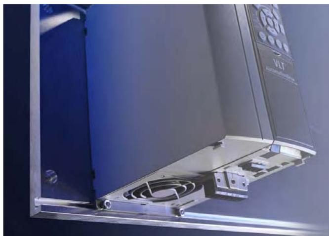
Un agent liquide circulant dans les plaques de montage DCP assure le refroidissement des composants électroniques avec une grande efficacité. La chaleur dissipée est ainsi évacuée en dehors de l'armoire ou du coffret sans altérer l'indice de protection élevé de l'armoire. Le refroidissement par agent liquide est non seulement silencieux, mais aussi mille fois plus efficace que celui utilisant l'air pour évacuer la chaleur dissipée.
