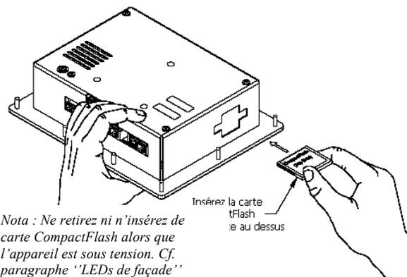
*Nota : Ne retirez ni n'insérez de carte CompactFlash alors que l'appareil est sous tension. Cf. paragraphe "LEDs de façade"*
