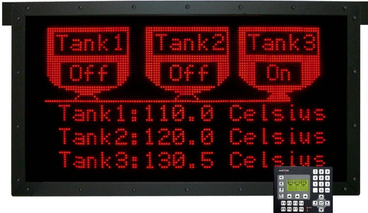
**Le BFD (Big Flexible Display)**, possède : une matrice à LED rouge de 128 x 64. Un port RS 485 qui permet de le connecter au Terminal Opérateur G303 dont l'affichage est recopié sur le BFD. Ainsi vos données sont visibles à 80 m.
