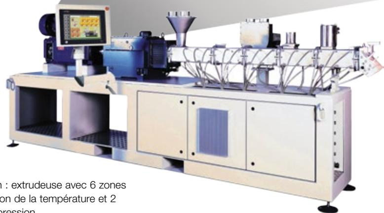
Application : extrudeuse avec 6 zones de régulation de la température et 2 zones de pression
