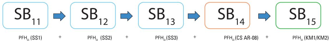
La fonction de sécurité 2 est réalisée par 2 sous-systèmes (SB) :
