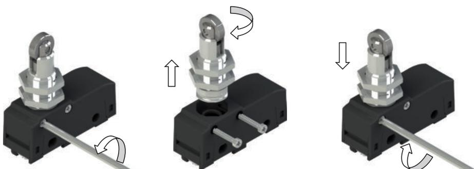
Grâce au système de fixation latérale breveté, il est possible de tourner le galet des micro-interrupteurs MK ●●15 et MK ●●17 par pas de 90°.
