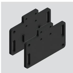
Plaque de fixation (avec vis de fixation) équipée de grandes fentes pour le réglage du point d'intervention. Chaque plaque a un double couple de trous de fixation, un à utiliser avec les interrupteurs standard et l'autre avec les interrupteurs avec réarmement. De cette manière, l'actionneur se placera toujours au même endroit final.
