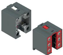
Bloc de contact avec vis imperdables, protège-doigts et contacts à double pont et double coupure pour une plus grande fiabilité de contact. Déclinés dans de nombreuses variantes avec des courses d'actionnement décalées, simultanées ou superposées. S'adaptent aux applications les plus variées.
