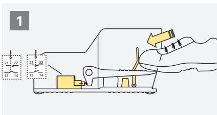
Pédale PX avec deux blocs de contact (2x 1NO+1NC) rupture rapide décalés, avec force d'actionnement à 2 positions et levier de sécurité.
