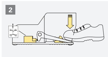
En appuyant l'actionneur de la pédale, les contacts commutent et le dispositif de blocage accroche l'actionneur.
