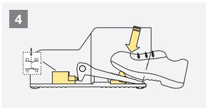
Pour débloquer l'actionneur de la pédale, appuyer sur le dispositif de blocage.
