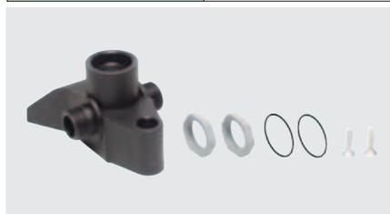
Kit d'assemblage pour pédales en technopolymère avec trou fileté M25x1,5 pour VF KIT31-VF KIT29 fourni avec écrous, garnitures et vis autoforeuses pour la fixation de deux pédales simples. Degré de protection IP65.
