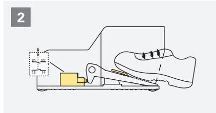
C'est seulement grâce à l'introduction complète du pied que l'on réussit à abaisser le levier de sécurité, ce qui permet l'actionnement de la pédale.
