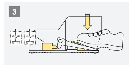
En appuyant avec une force plus grande (~180 N) sur l'actionneur de la pédale, l'autre bloc de contact commute aussi. Dans cette position, les deux unités de contacts sont commutées.
