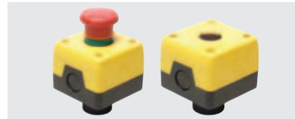
Kit bouton d'arrêt d'urgence à action mécanique positive conforme à EN 60947-5-1 et EN ISO 13850, à associer avec VF KIT31-VF KIT29 Degré de protection IP65.
