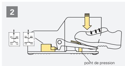
Avec une légère pression (~19 N) sur l'actionneur de la pédale, un des deux blocs de contact commute alors que l'autre garde son état inchangé. L'actionneur de la pédale s'arrête contre le point de pression.
