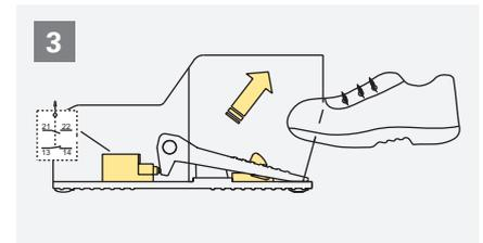
En relâchant l'actionneur de la pédale, le dispositif de blocage le maintient abaissé.
