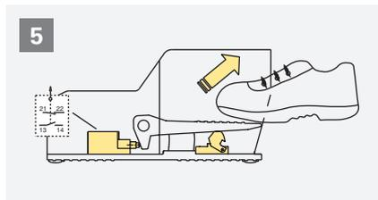
En enlevant le pied de la pédale, l'actionneur et les contacts se remettent dans la position initiale.
