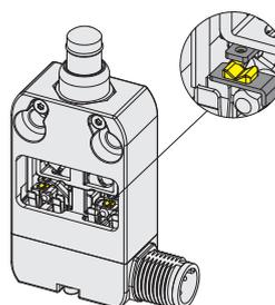
Les articles avec bloc de contact C11, C02, C12, C22 se distinguent par des contacts électriques en forme de V. Cette configuration réduit la probabilité d'erreur lors de l'actionnement et assure une commutation des contacts encore plus fiable grâce au doublement des points d'appui par rapport aux contacts plats et à l'action autonettoyante du contact. Disponibles en versions à rupture brusque, ces articles conviennent particulièrement bien à une utilisation dans le secteur ferroviaire.
