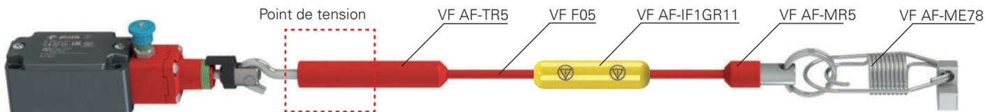
Cette combinaison d'accessoires est adaptée à des portées de longueur moyenne et grande (grâce à l'utilisation du ressort de sécurité VF AF-ME78) et quand les deux extrémités du câble sont distantes l'une de l'autre.
