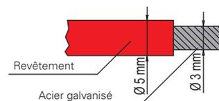
Le câble a été sélectionné pour résister dans le temps au manque d'entretien et aux agents atmosphériques.
