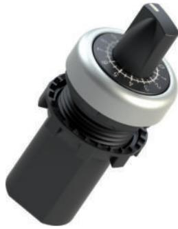
Grâce à leur forme monolithique, il a été possible d'intégrer dans le corps des potentiomètres de la série E6 tous les composants mécaniques et électriques nécessaires pour leur utilisation finale : aucune autre pièce, telle que des poignées ou des trimmers, ne doit être assemblée, il suffit d'insérer les fils du circuit dans le bornier incorporé.
