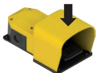
Les interrupteurs à pédales de la série PX sont dotés d'un capot particulier à profil renforcé. Cette solution permet au capot de supporter des charges statiques allant jusqu'à 800 N sans casse, et donc de résister au piétinement. Pour les environnements particulièrement exigeants, le capot peut être fourni dans un matériau renforcé à la fibre de verre pour résister également aux sollicitations de chocs
