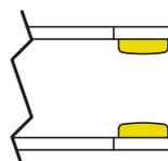
Les blocs de contact de ces dispositifs peuvent être fournis, sur demande, avec un revêtement en or. Idéal pour toutes les applications à basse tension ou de courant faible, garantissant ainsi une plus grande fiabilité de contact. Disponible en deux épaisseurs de 1 ou 2,5 microns, s'adaptant parfaitement aux différents domaines d'application, pour une longue durée de vie.
