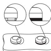
L'anneau façonné peut être utilisé s'il n'y a pas de porte-plaquettes ou d'autres dispositifs, il empêche le dépôt de saleté ou d'autres résidus entre l'indicateur et le panneau ou le boîtier. Ceci s'avère particulièrement utile, par exemple, dans les secteurs qui exigent un niveau élevé de propreté et d'hygiène.
