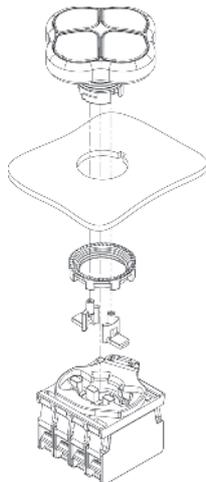
Le montage des 2 actionneurs latéraux, fournis avec le bouton quadruple, doit être effectué après la fixation du bouton.
