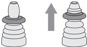
Pour éviter tout actionnement accidentel, le joystick peut être demandé dans les versions avec verrouillage central.
