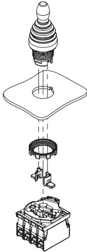
Le montage des 2 actionneurs latéraux, fournis avec le joystick, doit être effectué après la fixation du joystick.
