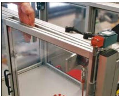
Vérification point de intervention selon EN 294, s'il est nécessaire recalibrer le point d'intervention.
