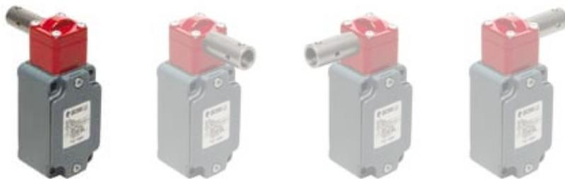
En enlevant les quatre vis de fixation, il est possible de tourner la tête de tous les interrupteurs de 90° en 90°.
