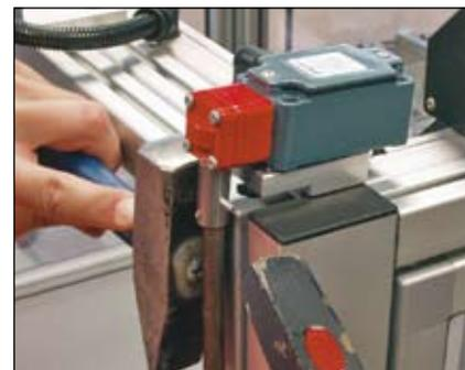
Fixation de la goupille d'arrêt (goupille en dotation).
