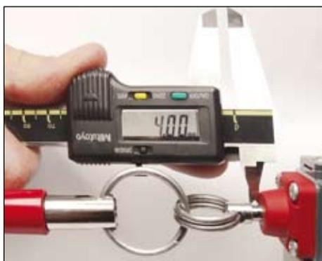
**Pour interrupteurs avec tête 74:** Mettre le câble relié à l'interrupteur sous tension, jusqu'à ce que le pivot est à 4 mm de la tête.
