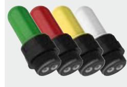
Les indicateurs lumineux servent à la visualisation du changement d'état du contact électrique à l'intérieur de l'interrupteur. Ils peuvent être installés sur les interrupteurs en les vissant à une des entrées pas utilisée pour le passage des câbles électriques. Degré de protection IP67.
